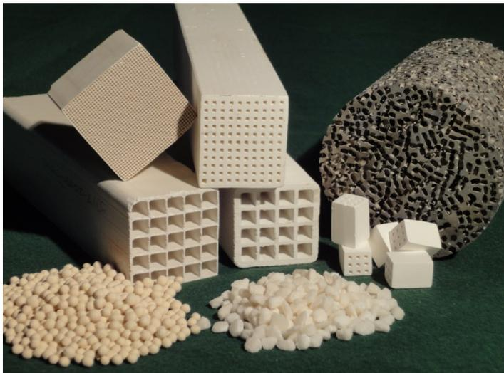
Abbildung 2: Beispiele verschiedener Speichermaterialien. Hinten links: extrudierte keramische und zeolithische Wabenstrukturen. Hinten rechts: metallischer Schaum. Vorne links: Zeolith-Granulat. Vorne rechts: kompaktiertes Salz-Granulat
