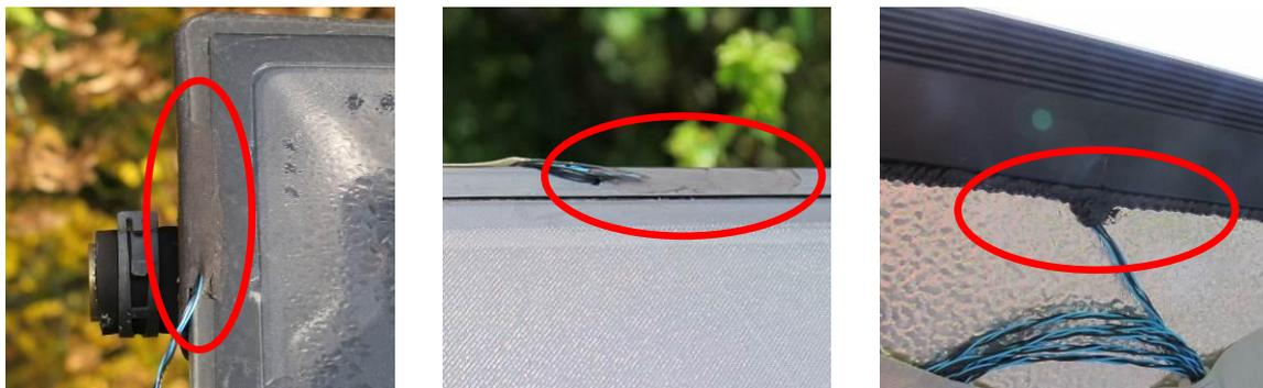
Abbildung 4: In die Klebefugen eingearbeitete Temperatursensoren; links: Vorderseite, in Anschlussnähe; Mitte: Vorderseite, mittig; rechts: Rückseite, mittig
