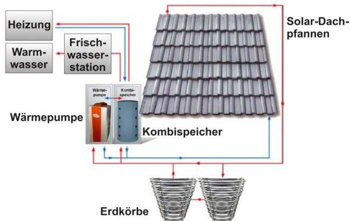
**Abb. 4: Vereinfachtes Hydraulikschema; Darstellung als Variante mit Kombispeicher [Quelle: Pro Solar Fertigungstechnik]**
