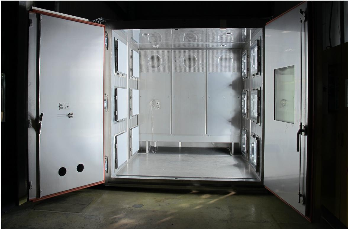
Abbildung 1: Klima-Simulations-Kammer „KlimSim“ für beschleunigte Alterungsprüfungen von Sonnenkollektoren
