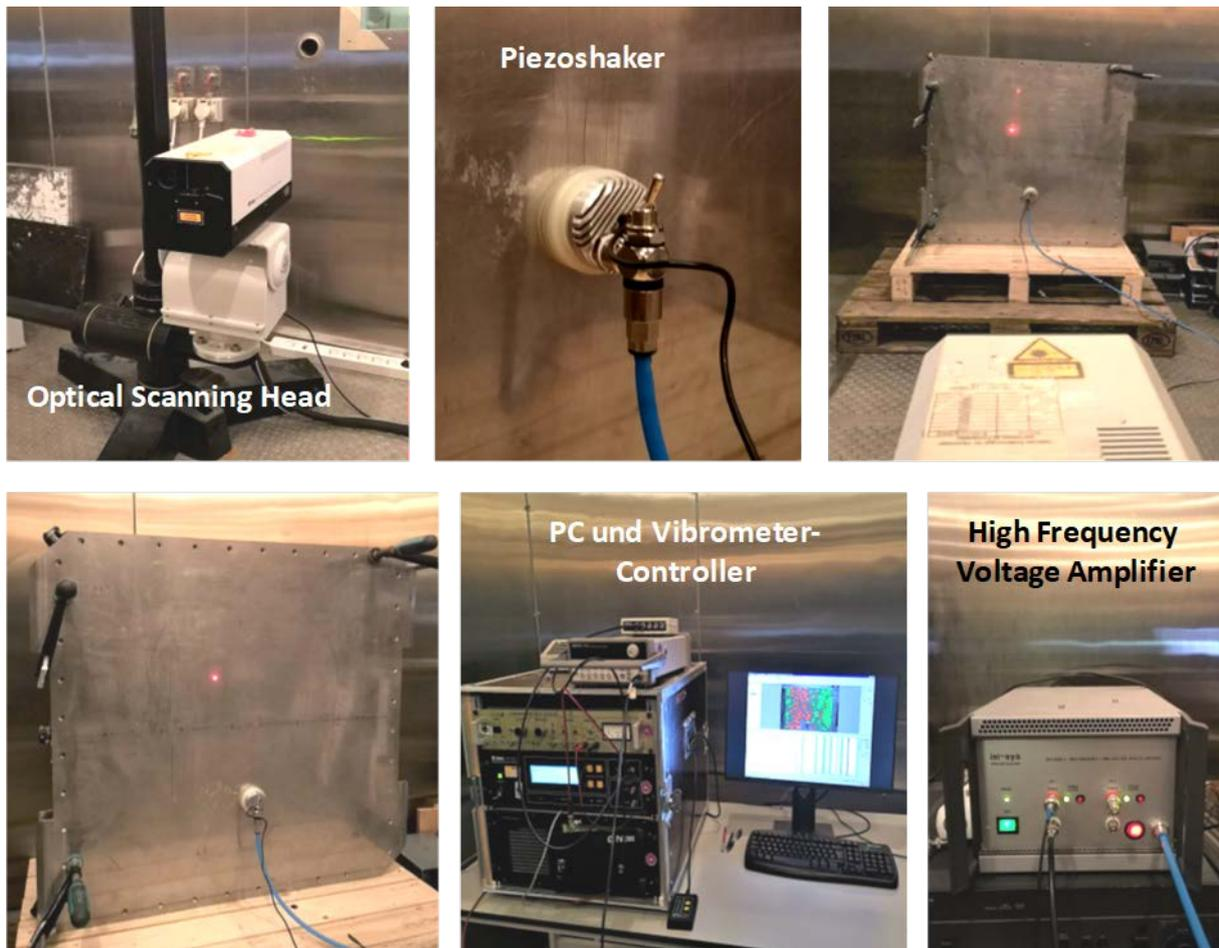
Abbildung 4-33: Versuchsaufbau der Vibrometriemessung zur Hohlraumdetektion in Perlit in einem Vakuumprobenbehälter.
