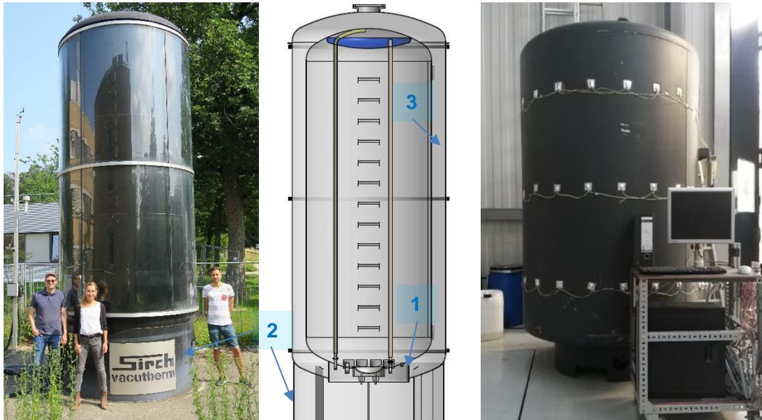
Abbildung 2-1: Warmwasserspeicher mit Vakuumwärmedämmung. Links: 12 m<sup>3</sup> Funktionsmusterspeicher am Außenprüfstand des IGTE; Mitte: 12 m<sup>3</sup> Funktionsmusterspeicher in CAD-Darstellung mit Standzarge (1), Standring (2) und Doppelmantel bzw. Dämmraum (3); rechts: 1,5 m<sup>3</sup> Funktionsmusterspeicher im Technikumsmaßstab am Innenprüfstand des IGTE.
