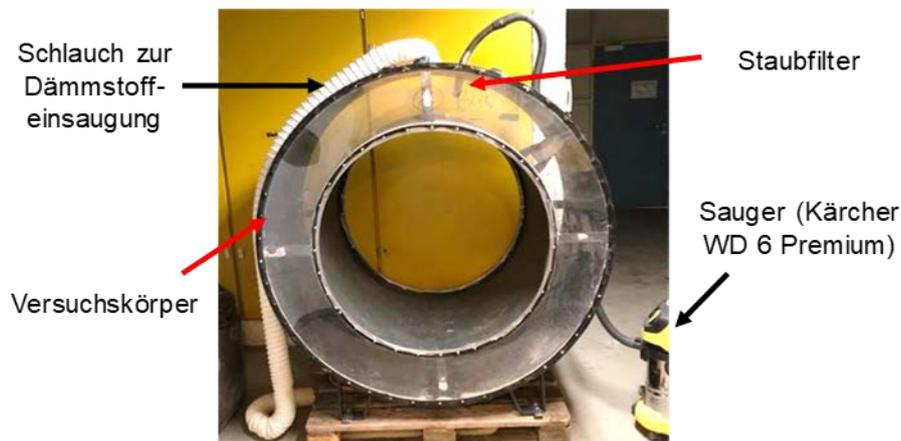
Abbildung 4-11: Versuchsaufbau 1 zur radialen Einsaugung.
