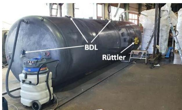
Abbildung 4-30: Positionen der Beschleunigungsdatenlogger und Rüttler beim Pilotspeicher Kirchdorf.
