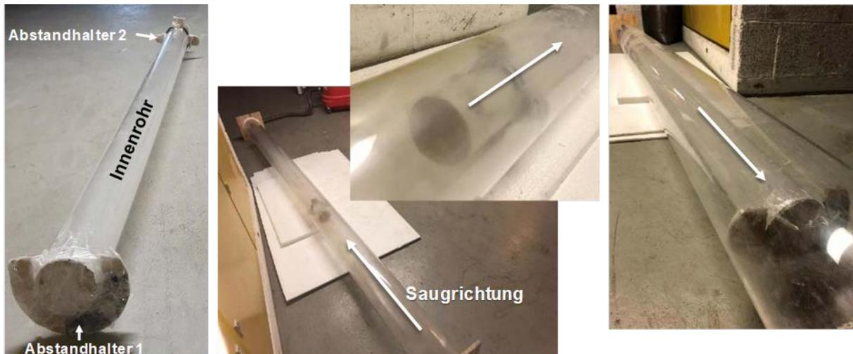
Abbildung 4-16: Versuchsaufbau zur axialen Dämmstoffeinsaugung im Labormaßstab mit Innenrohr.
