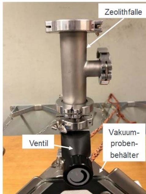
Abbildung 4-46: Versuchsaufbau zur Untersuchung der Wirkung einer Zeolithfalle zur Druckabsenkung des mit Perlit TPC1,5 gefüllten VPB im Labormaßstab.
