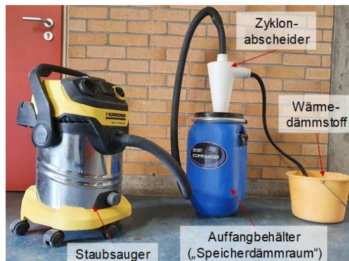
Abbildung 4-7: Versuchsaufbau zur Dämmstoffeinsaugung durch einen Zyklonabscheider im Labormaßstab. Staubsauger: Kärcher WD 6 Premium
