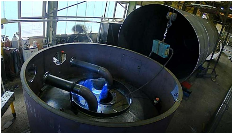
Abbildung 7-1: Fertigung des äußeren Speicherbehälters und des Fußrings von Pilotspeicher 1
