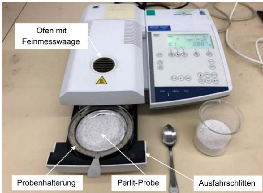
Abbildung 4-43: Versuchsaufbau zur Bestimmung des relativen massenbezogenen Feuchtegehalts von expandiertem Perlit mit dem Gerät HG63 des Herstellers Mettler Toledo.
