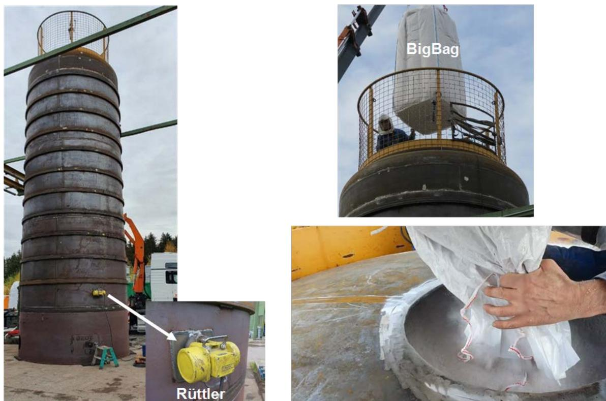
Abbildung 4-2: Stand der Technik der Dämmstoffbefüllung bei der Firma Sirch zu Beginn des Projekts StoEx2. Links stehender Speicher mit Rüttler; rechts oben: BigBag über Befüllungsöffnung; rechts unten: Öffnen des BigBags und schwerkraftbetriebene Befüllung in Öffnung des Speicherdämmraums
