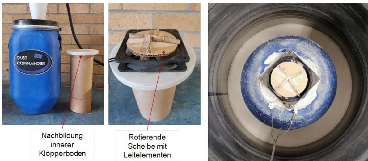
Abbildung 4-8: Vorrichtungen zur Untersuchung der Dämmstoffverteilung in einem Ringspalt durch eine rotierende Scheibe im Labormaßstab. Links: geschlossener Versuchsaufbau in Kombination mit Dämmstoffbefüllung durch Zyklonabscheider; rechts: offener Versuchsaufbau mit händischer Befüllung zur Visualisierung des Prozesses.
