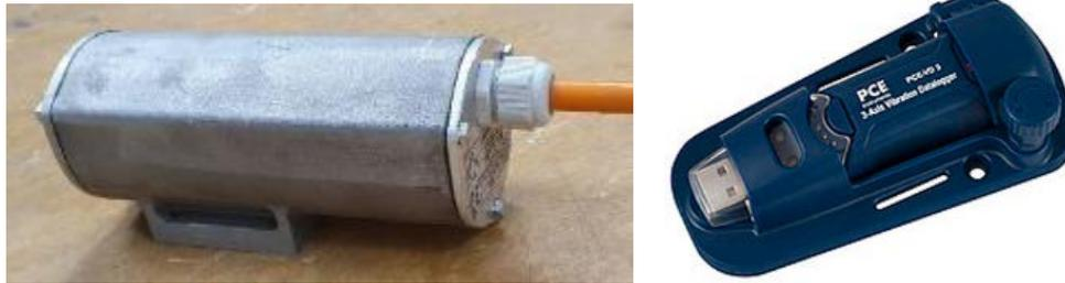
Abbildung 4-21: Für Laborversuche verwendeter Rüttler der Firma Brecon (links) und Beschleunigungsdatenlogger PCE-VD 3 von PCE Instruments (rechts) [PCE 2024]
