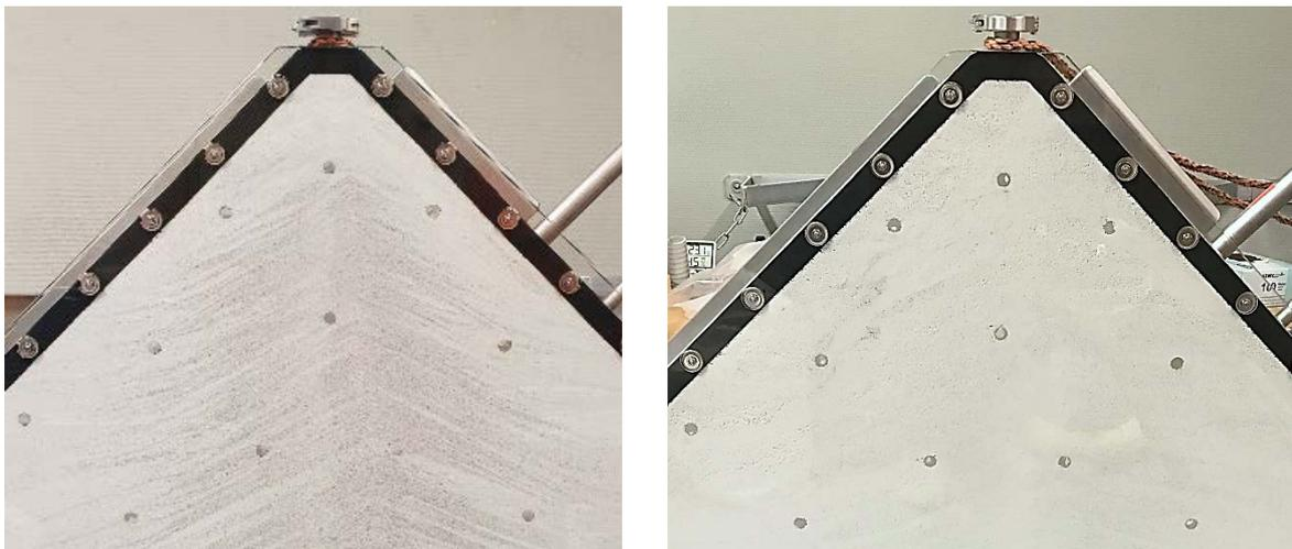
Abbildung 4-5: Homogenität der Perlit-Dämmstoffschüttung nach dem Einsaugen in den VPB. Links: Perlit-Charge mit einer Dichte der losen Schüttung von  $275 \text{ kg/m}^3$ ; rechts: Perlit-Charge mit einer Dichte der losen Schüttung von  $58 \text{ kg/m}^3$
