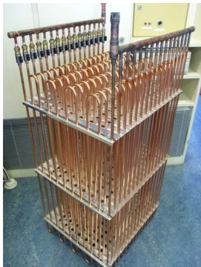
Abb. 4.1: Entwicklungsschritte des Wärmeübertragers aus Kupfer
