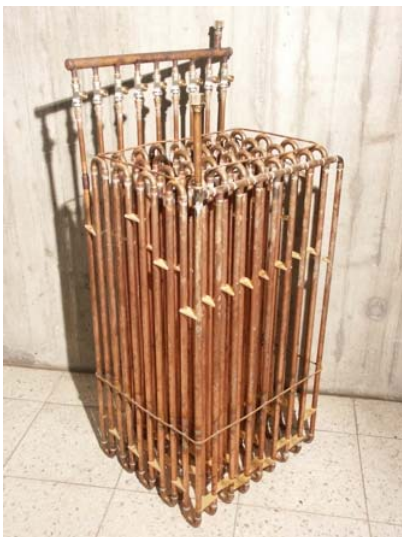
Abb. 4.1: Entwicklungsschritte des Wärmeübertragers aus Kupfer
