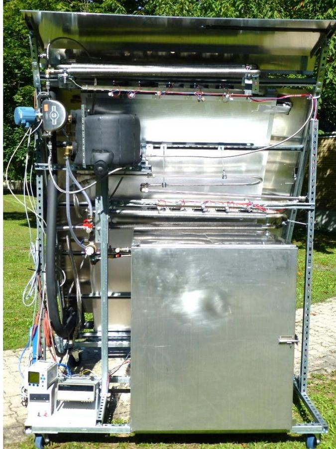
*Abbildung II-36: Demonstrationsanlage eines solarthermisch angetriebenen, autarken Kühlschranks*
