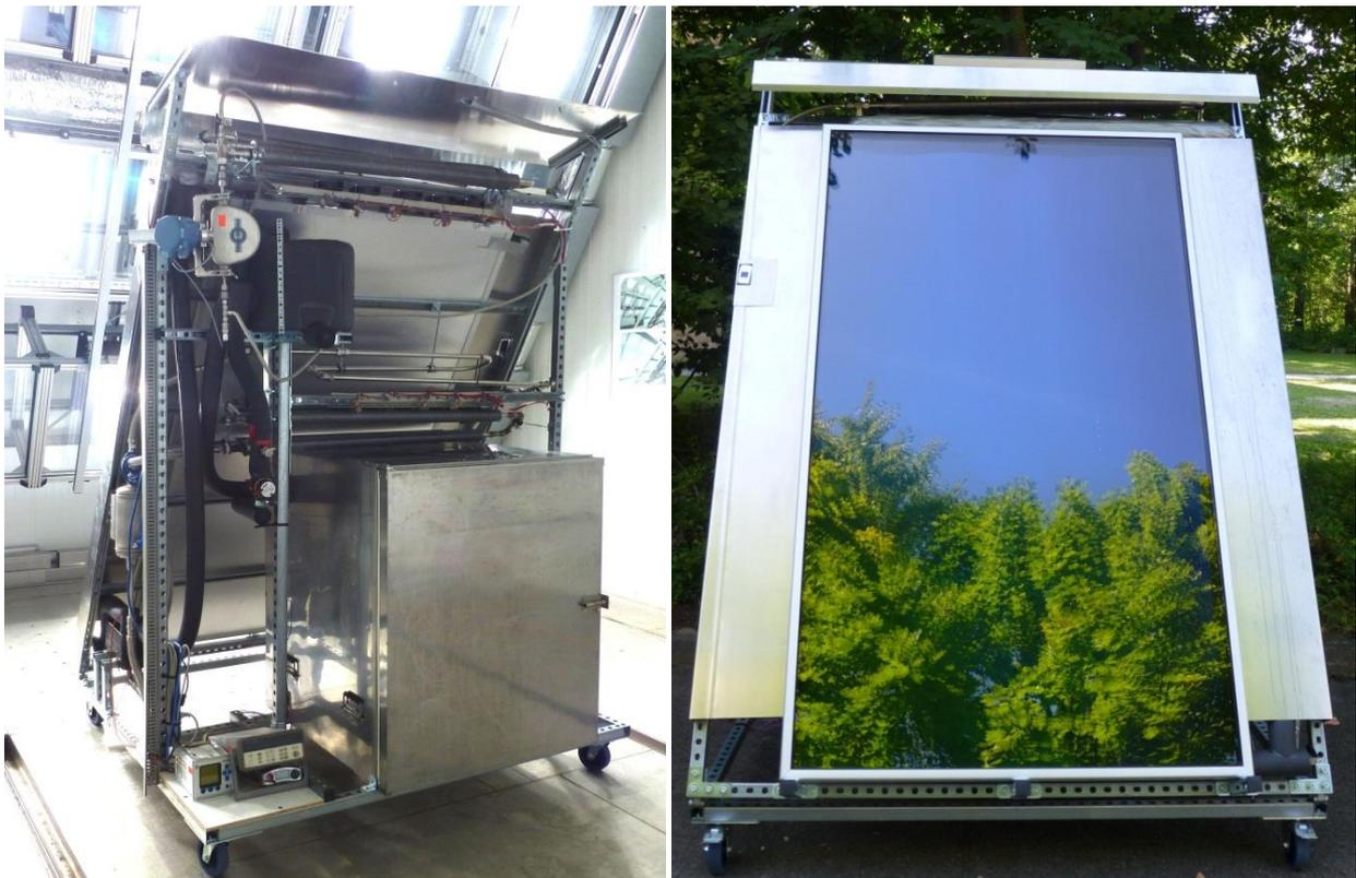
Abbildung II-34: DAKM bei Vermessung im Sonnensimulator (links) und im Freiluftprüfstand (rechts)
