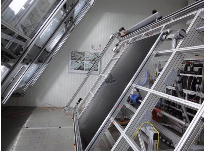
*Abbildung II-25: Vermessung des Kollektoraustreibers im Sonnensimulator*
