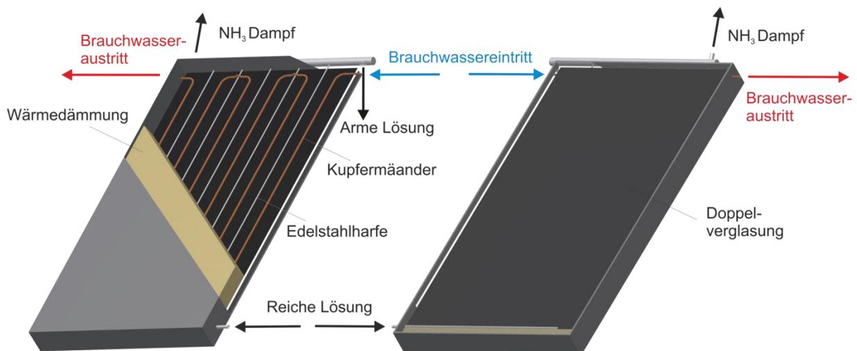
Abbildung II-20: Solarbeheizter Kollektoraustreiber mit integrierter Brauchwassererwärmung
