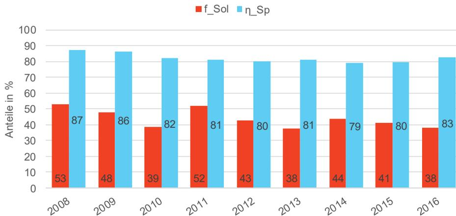
Abbildung 111: Solarer Deckungsanteil  $f_{Sol}$  und Speichernutzungsgrad  $\eta_{Sp}$  des jeweiligen Kalenderjahres
