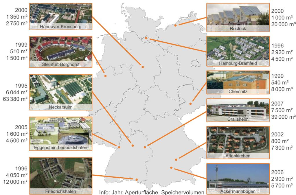
Abbildung 1: Seit 1995 in Deutschland errichtete SuN-Anlagen mit saisonaler Wärmespeicherung
