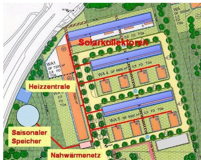
Abbildung 99: Schematische Darstellung der SuN am Ackermannbogen: Nahwärmenetz (rot), versorgte Gebäude (orange), versorgte Gebäude mit Indach-Kollektoren (violett) und saisonaler Wärmespeicher. [Dallmayer et al. 2010]
