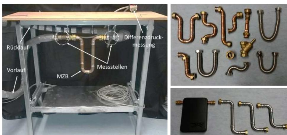
**Abbildung 33:** Positionierung und hydraulische Verschaltung der relevanten Komponenten der Druckverlustmessung (links); Auswahl zur Verfügung stehender Mikrozirkulationsbremsen (rechts)
