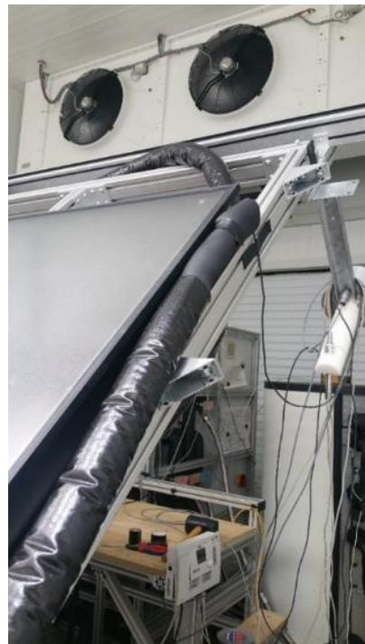
**Abbildung 70:** Speicher mit Mikrozirkulationsbremsen (MZB) und sorgfältig wärmegeädämmten Anschlüssen (links) und Kollektor mit Wärmedämmung am Kollektorausritt
