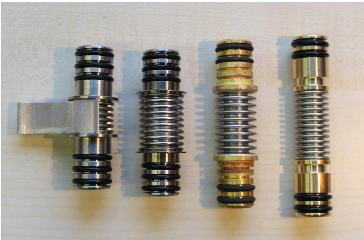
Abbildung 16: Unterschiedliche Kollektorverbinder
