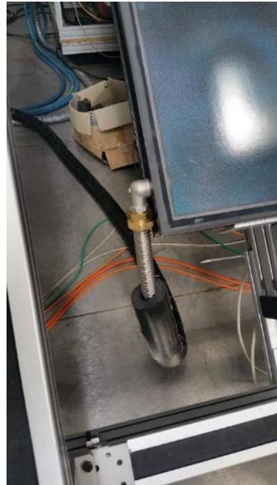
**Abbildung 68:** Speicher und Kollektor mit nicht wärmegeklämmten Anschlüssen
