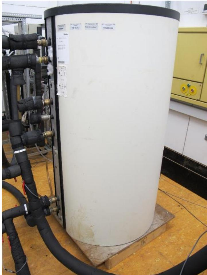
Abbildung 67: Trinkwasserspeicher mit nicht wärmegeklämmten Anschlüssen
