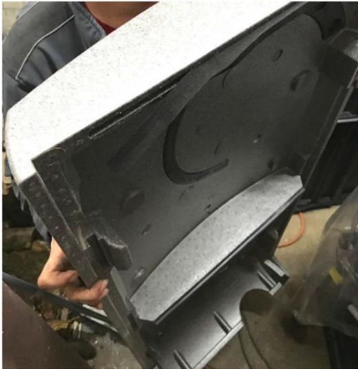
Abbildung 4: Herausrutschende Gummilippen der neuen steckbaren Isolierung
