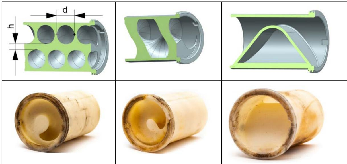
**Abbildung 40:** Varianten 4 bis 6 (von links nach rechts) der MZB
