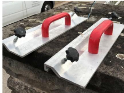
Abbildung 10: Transporthilfe für die Kollektoren
