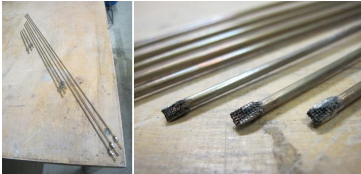
Abbildung 45: Messingröhrchen für den Einbau der Thermolemente in die Zeolithschüttung
