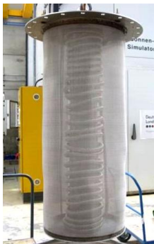
Abbildung 35: Wärmeübertrager aus Wellrohr
