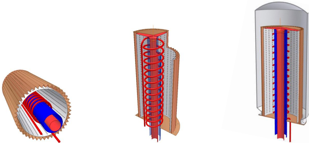
Abbildung 37: Zeichnungen des Sorptionswärmespeichers und des kombinierten Speichers
