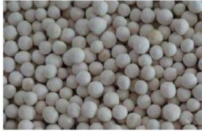
Abbildung 4: Synthetisch hergestellter Zeolith in Kugelform (Kugeldurchmesser ca. 2 mm)
