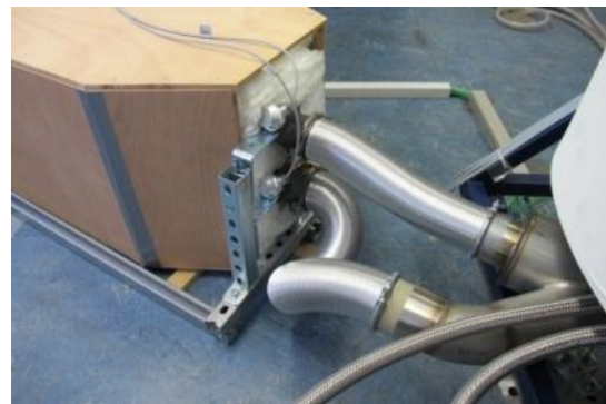
Abbildung 42: Luft/Luft-Wärmeübertrager mit Dämmung
