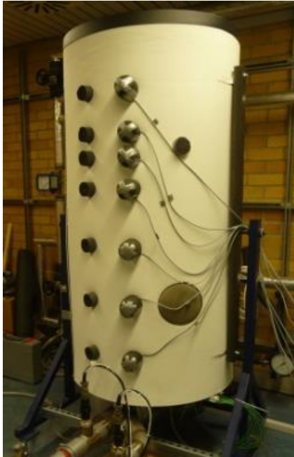
Abbildung 53: Kombiniertes Warmwasser-Sorptionswärmespeicher mit Dämmung und Messtechnik
