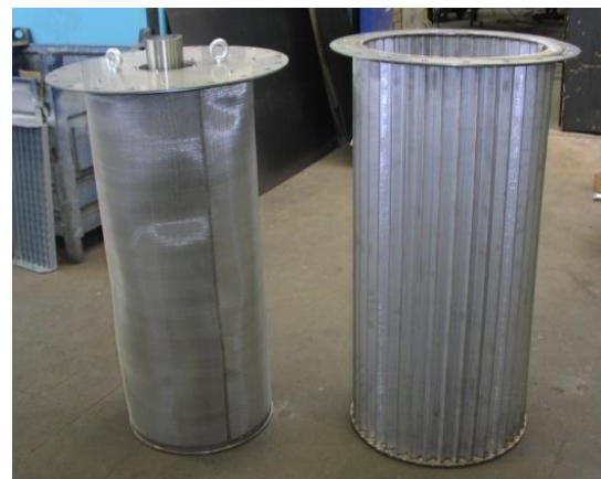
Abbildung 34: Sorptionswärmespeicher, innerer Behälter aus Metallgewebe (links), äußere Hülle aus Edelstahlblech (rechts)
