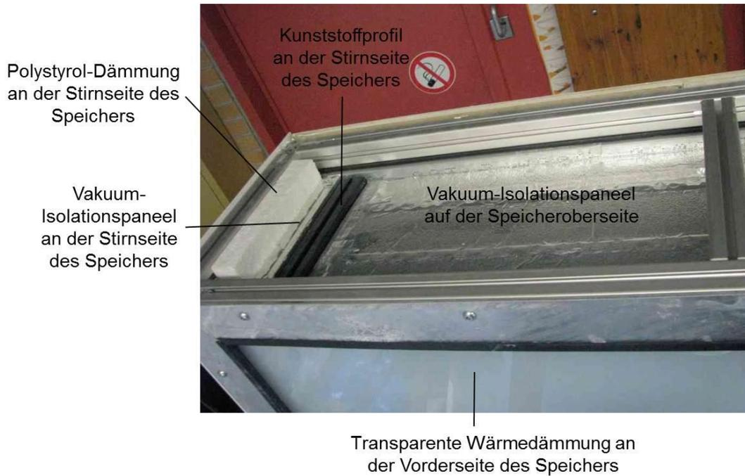
**Abb. 5.5:** *Vakuumdämmung an den Stirnseiten und auf der Speicheroberseite, transparente Wärmedämmung an der Vorderseite des Speichers*
