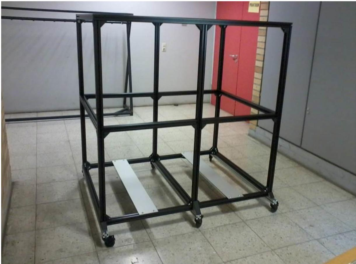
**Abb. 5.33:** Foto der aufgebauten Rahmenkonstruktion des Hydraulikmoduls
