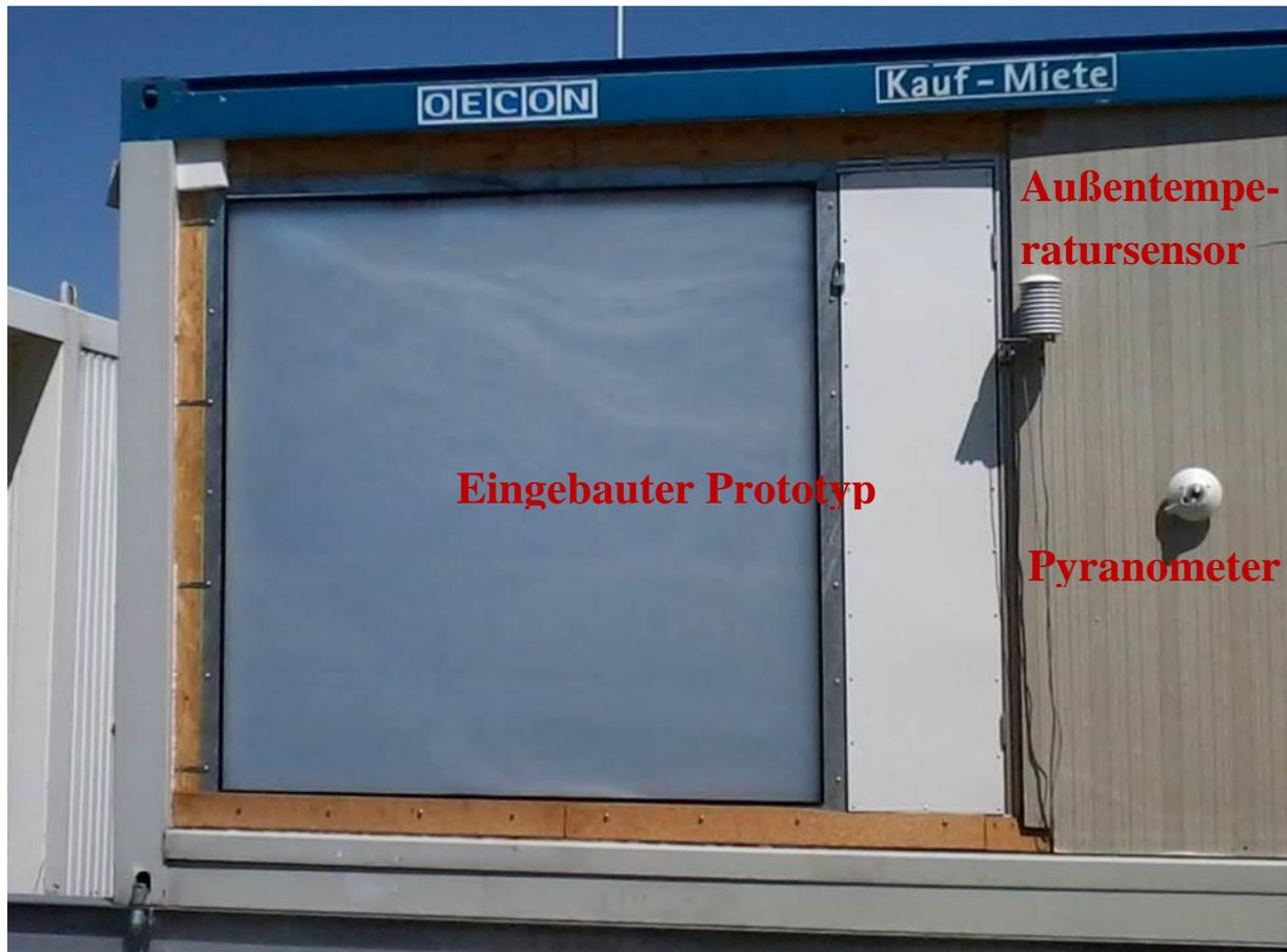
**Abb. 7.2:** In den Container eingebauter Prototyp
