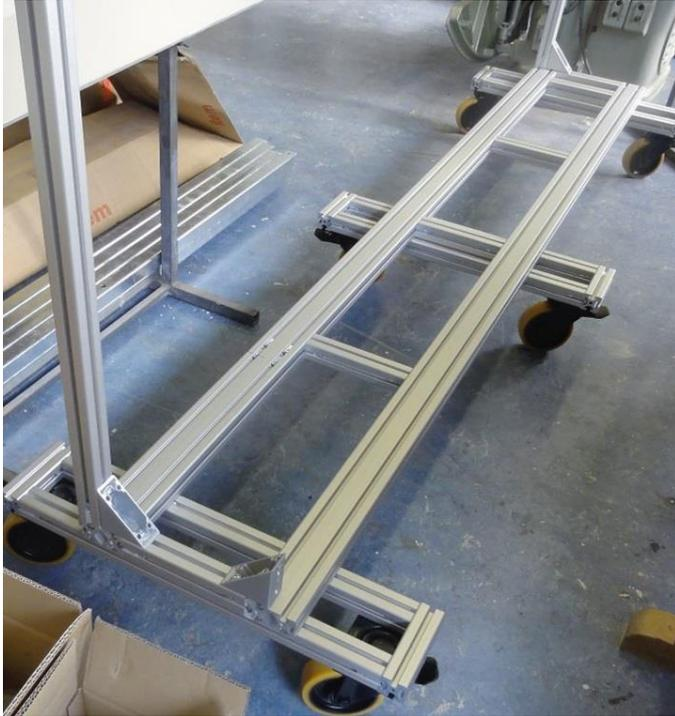
*Aufgebaute Unterkonstruktion mit Teil des Modulrahmens*
