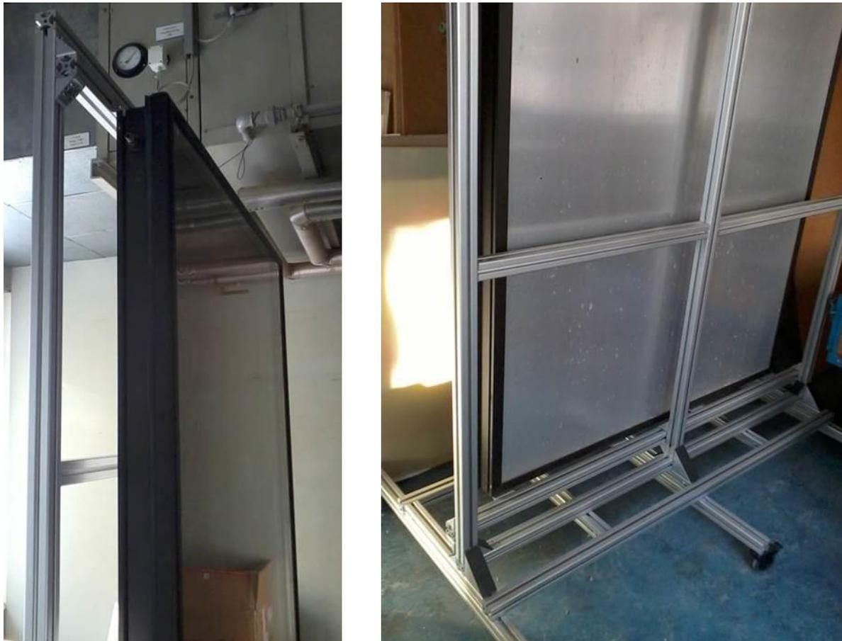
**Abb. 5.31:** Fotos der an den transportablen Gerüsten befestigten Flachkollektoren im Labor; Vorderseite oben (links), Rückseite unten (rechts)
