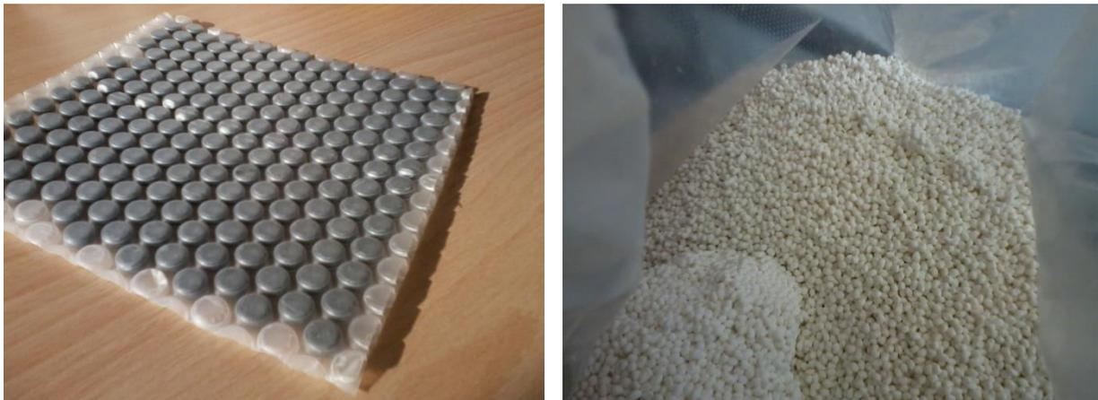
**Abb. 5.17:** Mögliche Phasenwechselmaterialien für den PCM-Speicher: Mit PCM gefüllte PP-Matten (links), Verbundmaterial aus PCM und einer Polymerstruktur (rechts)
