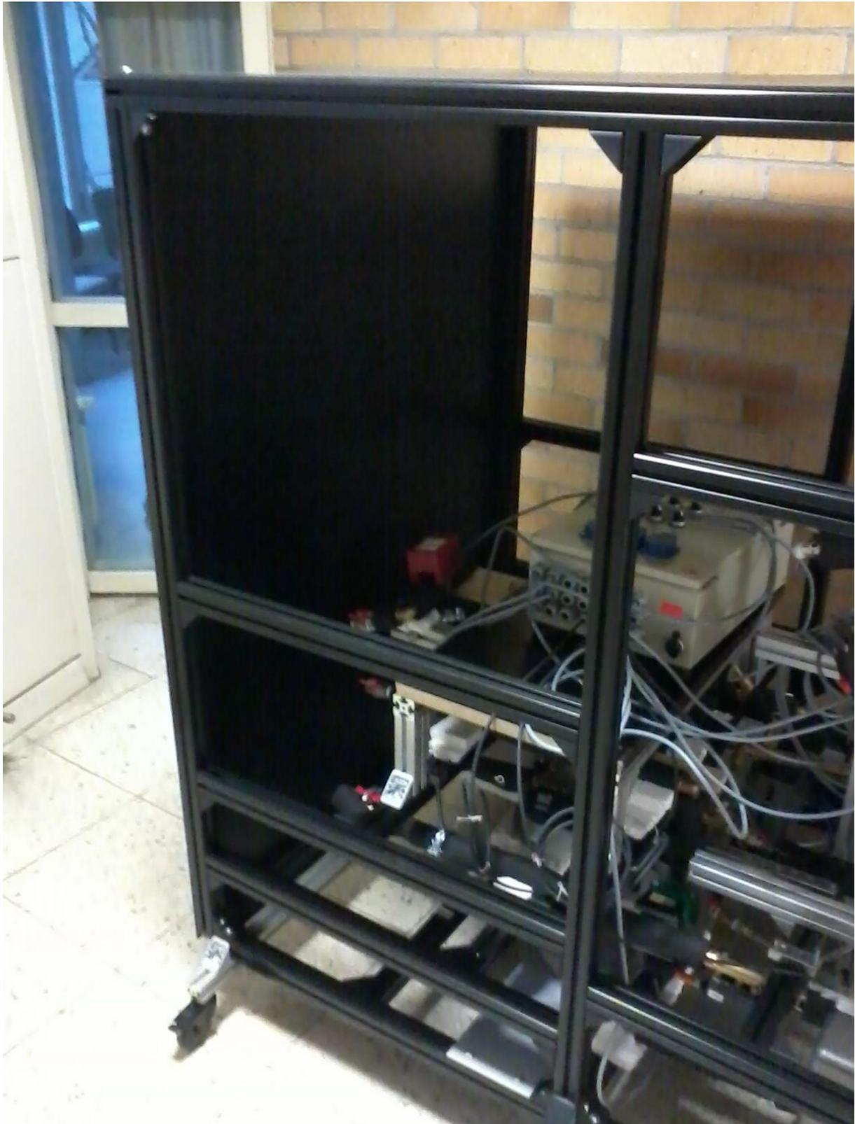
**Abb. 5.36:** Foto des fast fertig aufgebauten Hydraulikmoduls inklusive Schaltschrank für die Stromversorgung von Pumpen, Ventil und Sensoren (mit einem Teil der äußeren Abdeckung auf der linken Seite)
