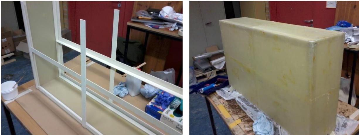
**Abb. 5.20:** Fotos vom Aufbau der GFK-Speicher im Labor: Gerüst aus GFK-Profilen mit einigen aufgeklebten GFK-Platten (links), Speicherbehälter nach dem Laminieren (rechts)
