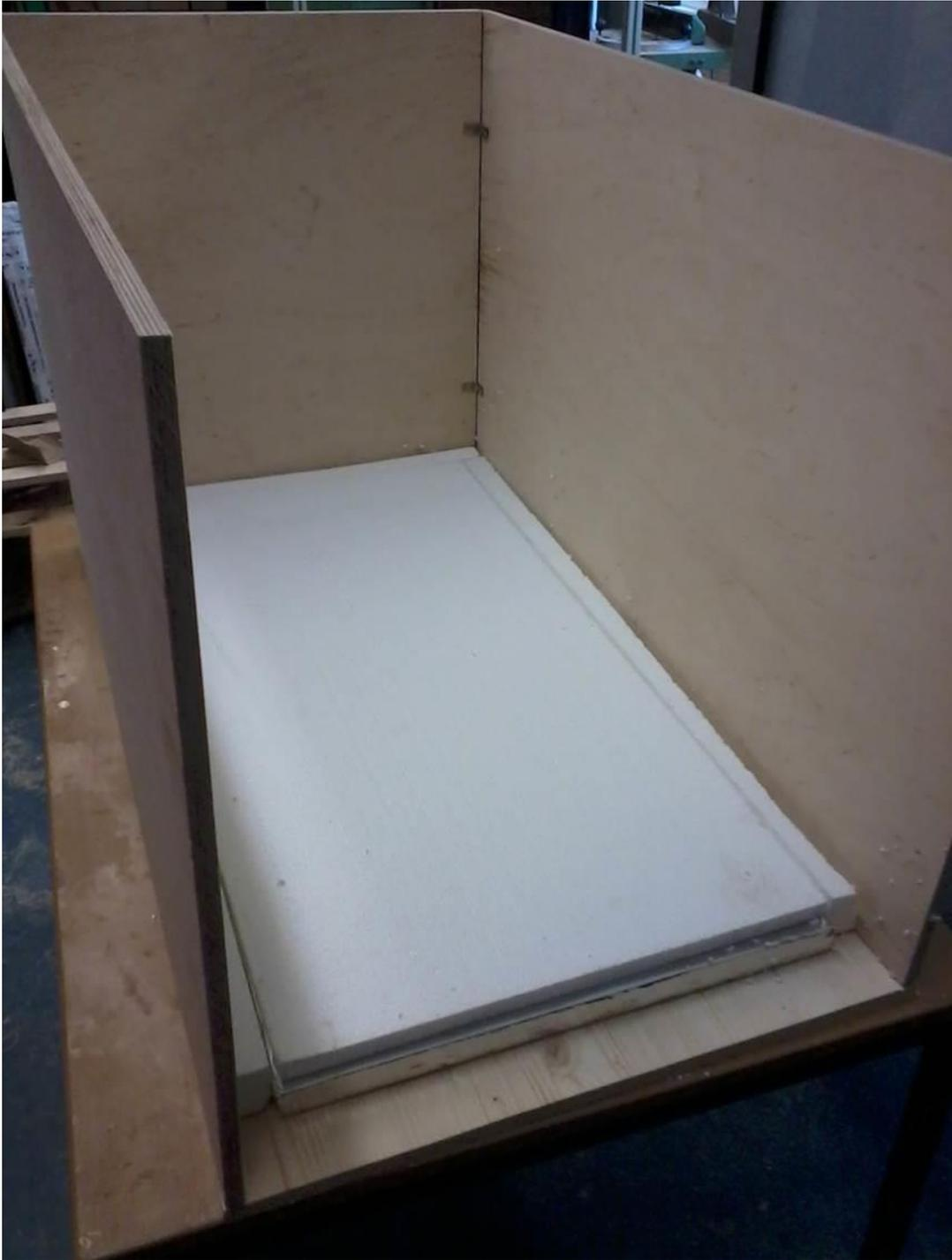
*Abb. 5.25: Teil der Holzrahmenkonstruktion mit Vakuum-Isolationspaneel zur Wärmedämmung der Speicherunterseite*
