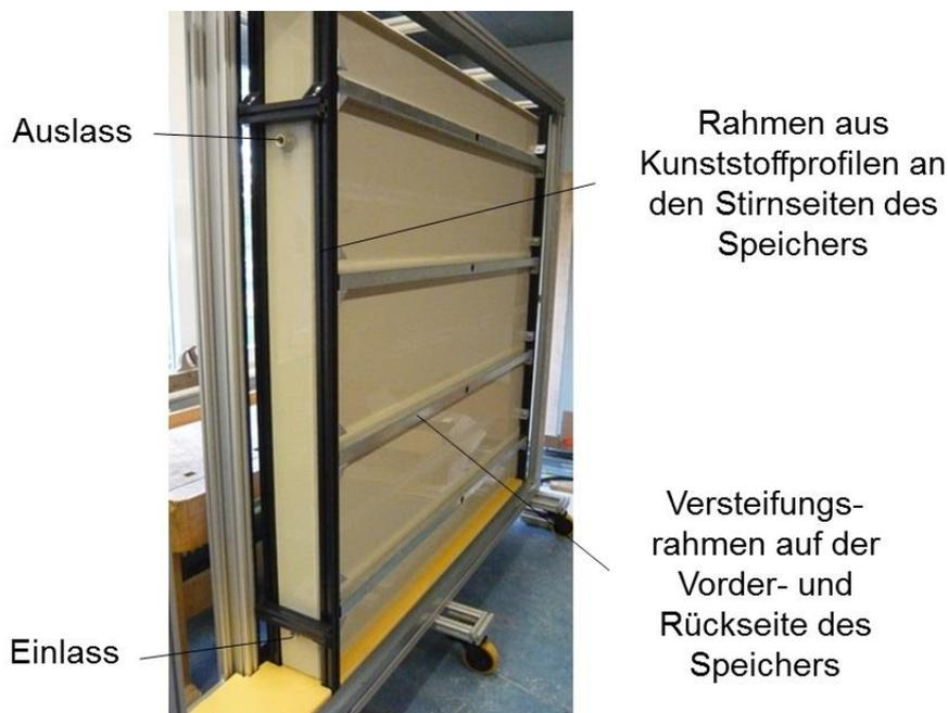
**Abb. 5.3:** Rückseite des Speichers mit den horizontalen Versteifungsrahmen und Stirnseite mit Einlass, Auslass und dem Rahmen aus Kunststoffprofilen zur Fixierung des Speichers
