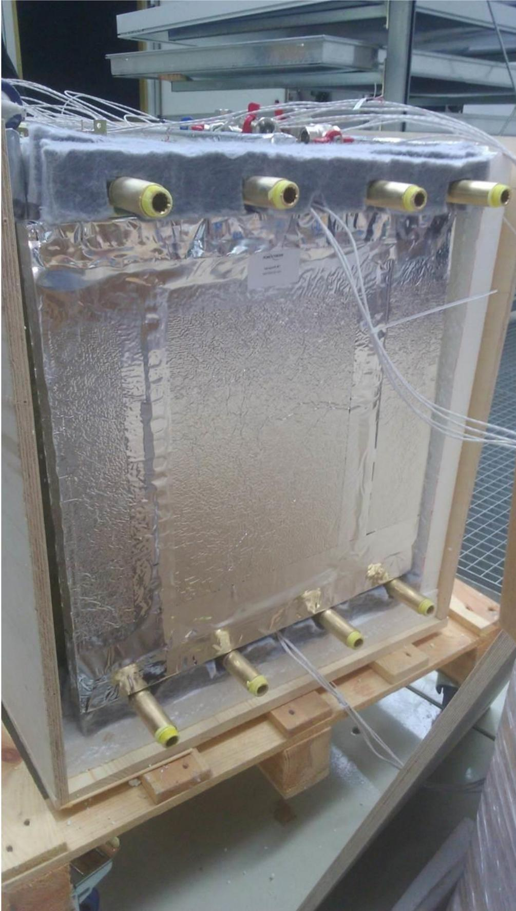
*Abb. 5.27: Vorderseitige Wärmedämmung der beiden Speicherbehälter*
