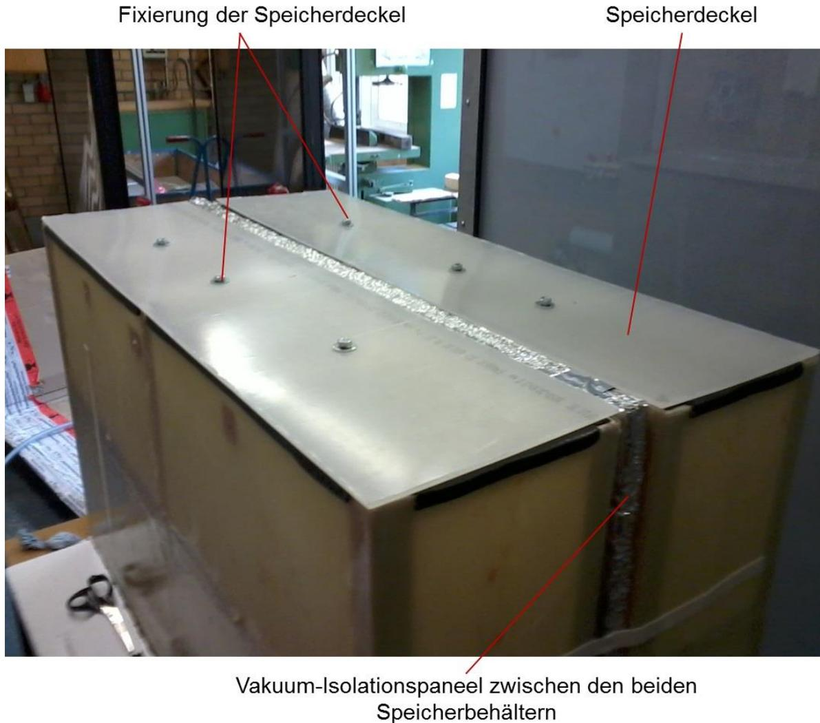
*Abb. 5.23: Speicher mit Darstellung der Befestigung der beiden Speicherdeckel*
