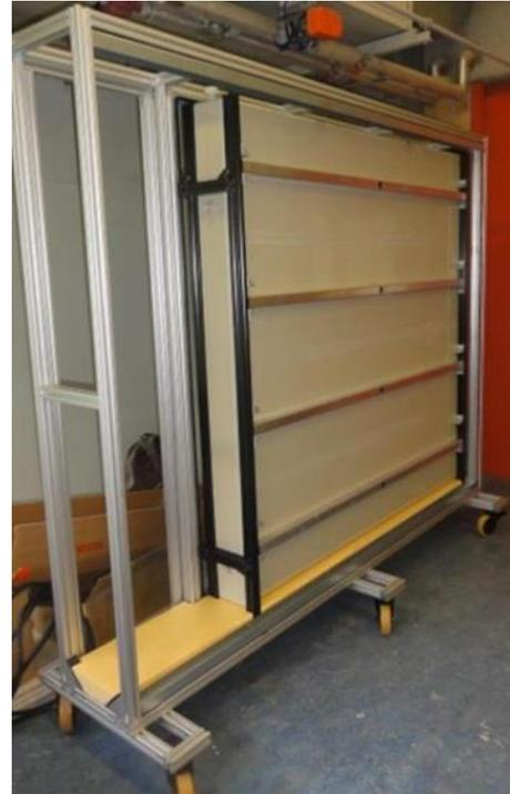
*Eingebauter Speicher mit Versteifungsrahmen*
