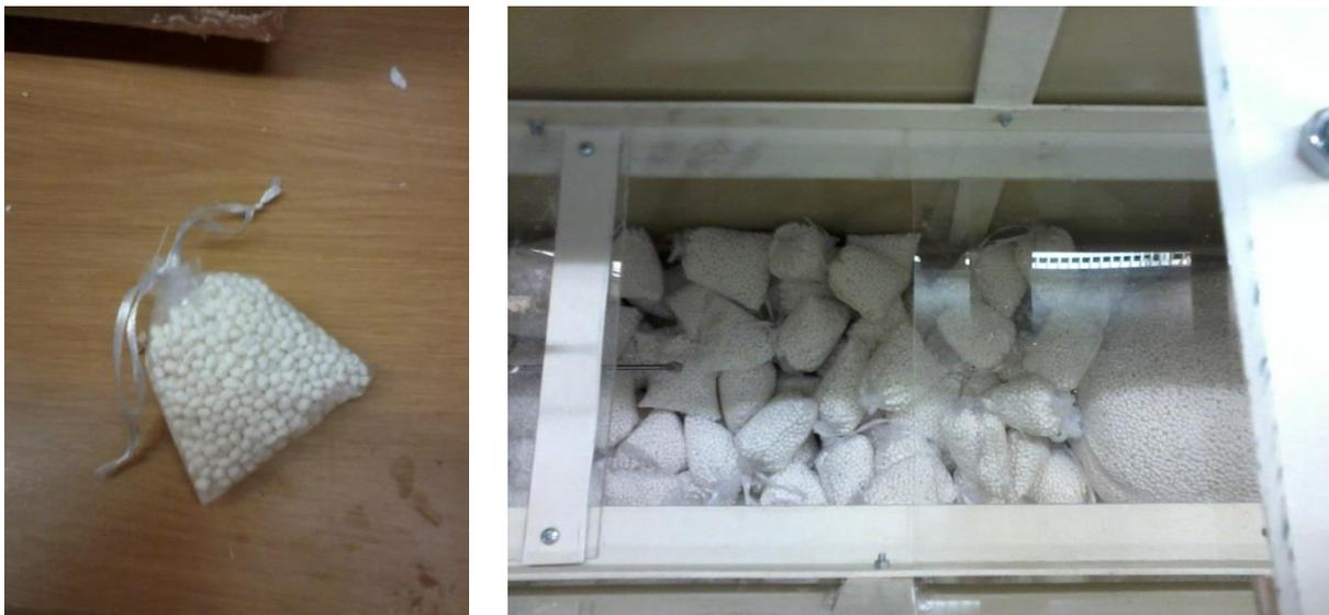
**Abb. 5.18:** In kleine Stoffsäckchen eingefülltes PCM (links), mit diesen PCM-Stoffsäckchen teilweise gefüllter Speicher (rechts)
