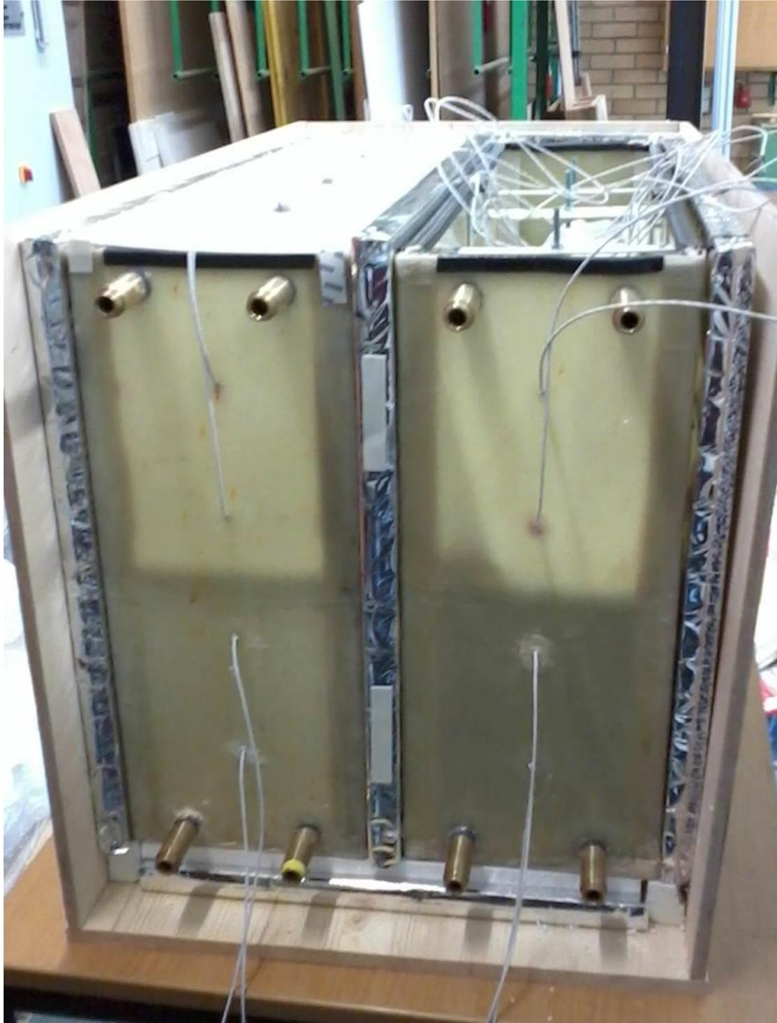
*Abb. 5.26: Vakuumgedämmte Speicherbehälter integriert in die Holzrahmenkonstruktion*
