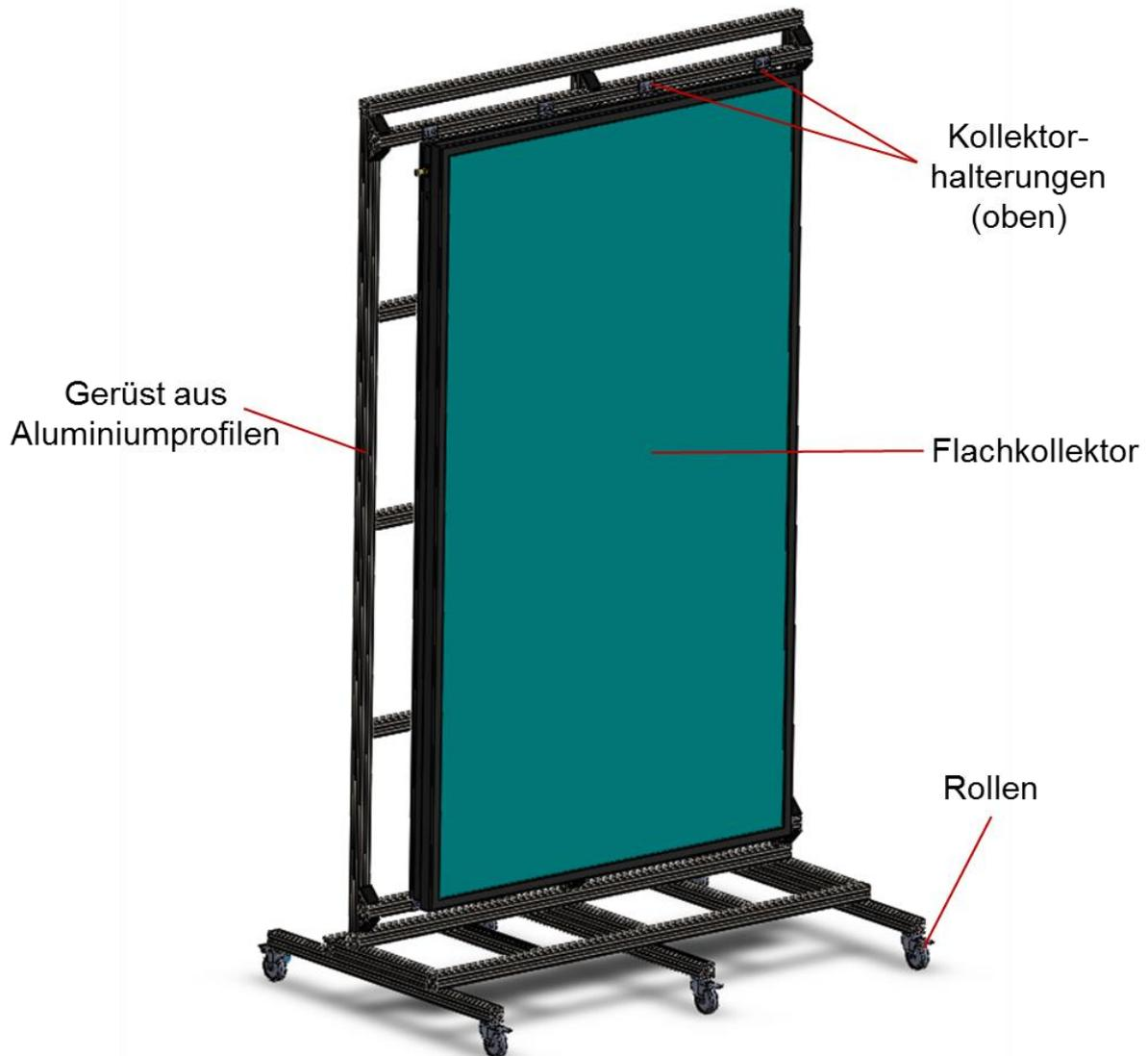
**Abb. 5.30:** CAD-Zeichnung eines an einem transportablen Gerüst befestigten Flachkollektors
