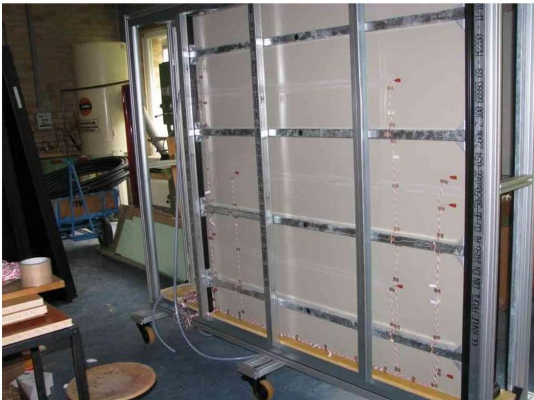
*Rückseite des Speichers mit aufgeklebten Pt100-Anlegetemperaturfühlern*
