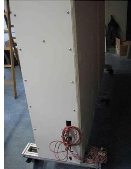
*Stirnseite des Prototyps mit angeschraubter Abdeckung und hydraulischen Anschlüssen für die Warmwasserzapfung*
