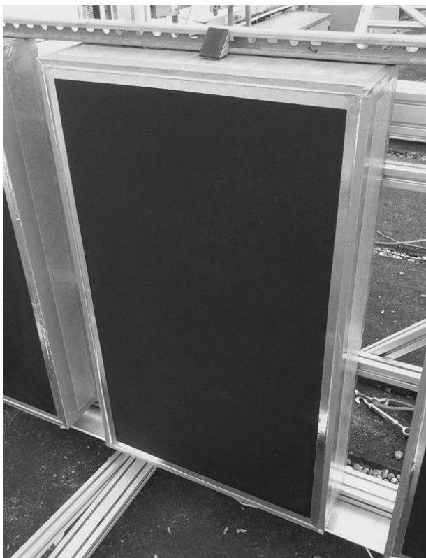
Abbildung 13. Versuchsträger ohne TWD-Strukturen (links) und Anordnung der Temperatursensoren auf der Rückseite des Absorberblechs eines Versuchsträgers bzw. geometrische Abmessungen des Absorberblechs in der Einheit mm (rechts)
