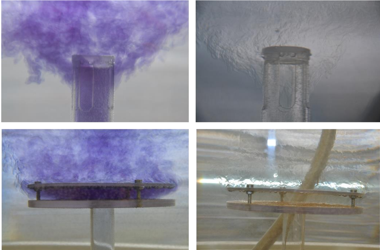
Abbildung 81. Nahaufnahme des Ausströmens von Beladefluid aus der Beladelanze (oben) und dem Plattenbelader (unten) während einer Beladesequenz; Strömungsmarkierung mit der Methode der Strömungsmarkierung (links) und der Methode der Schlierenoptik (rechts)
