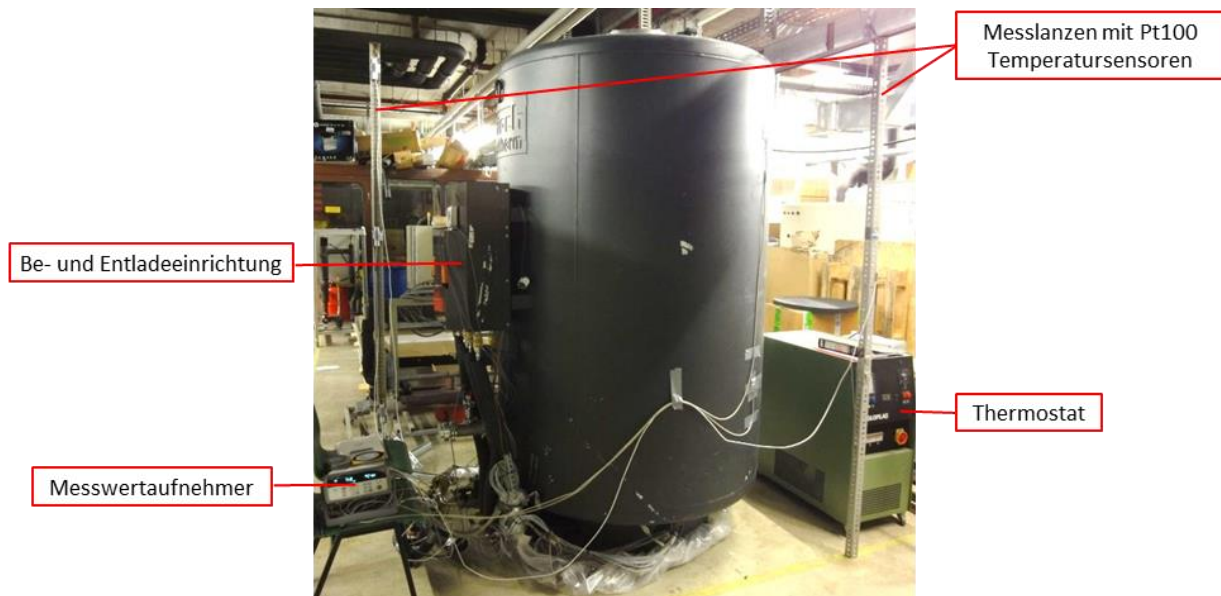
Abbildung 27. Funktionsmuster-Speicher; Versuchsaufbau für die Messung der Wärmeverluste
