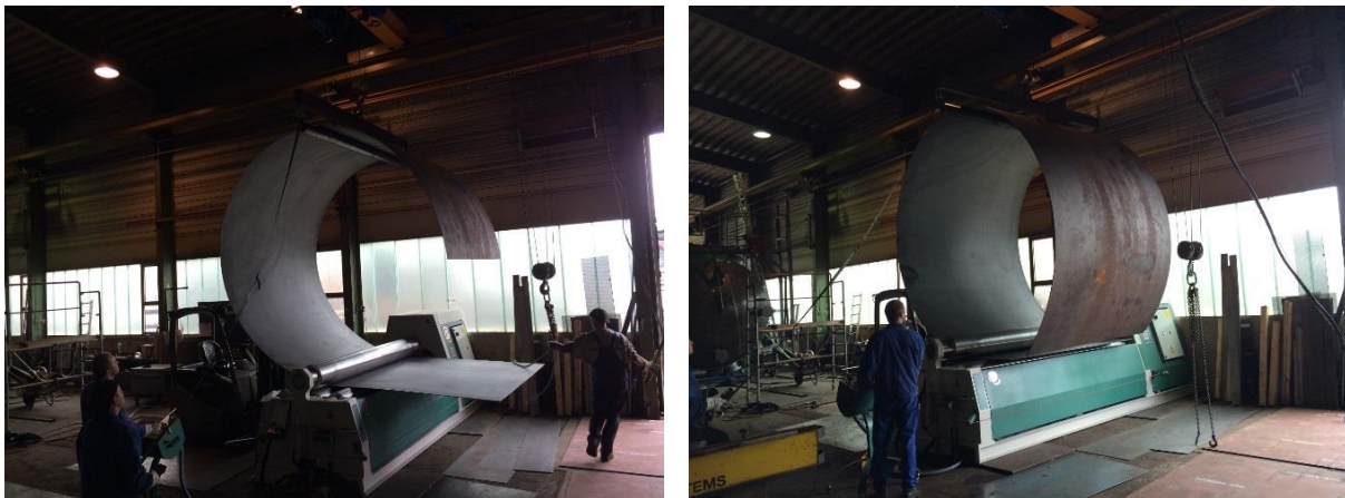
Abbildung 42. Rundungsvorgang des Mantels (links) und Walze mit gerundetem Mantel (rechts)
