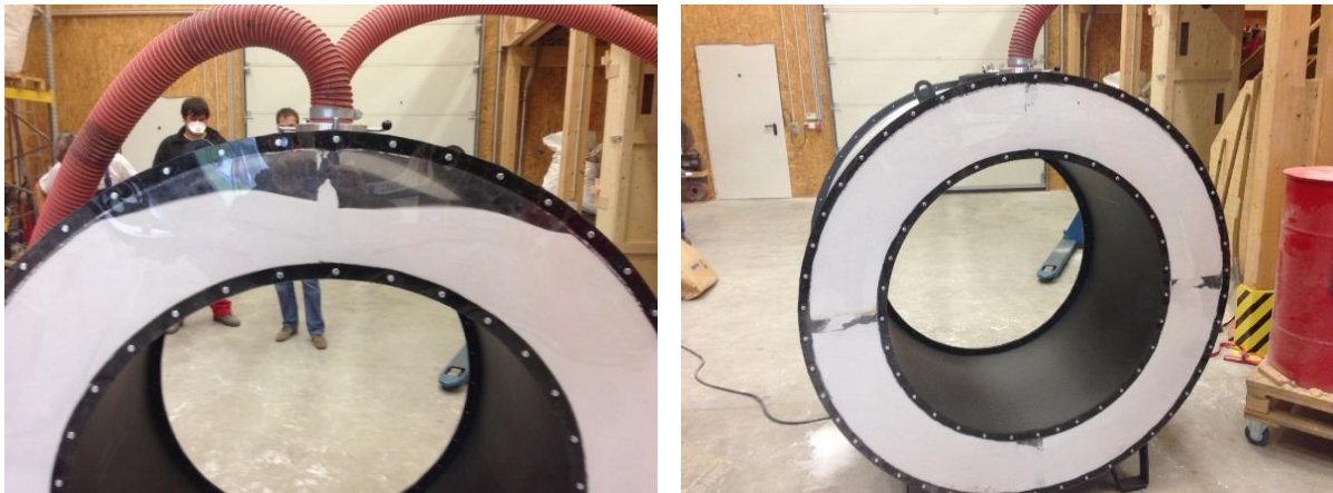
Abbildung 39. Schnittmodell, endender Füllversuch (links) und vollständig gefülltes Schnittmodell (rechts)
