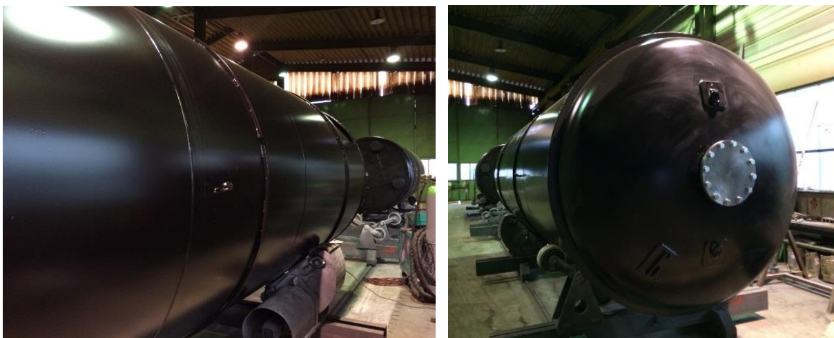
Abbildung 48. Funktionsmuster mit Speziallack beschichtet
