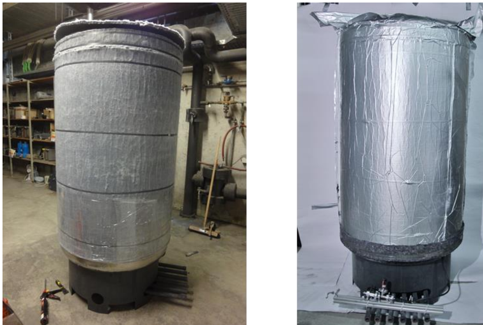
Abbildung 31. Funktionsmuster-Speicher mit Aerogelmatten-Umhüllung (links) und mit zusätzlicher Folienumhüllung und evakuierter Wärmedämmung (rechts)
