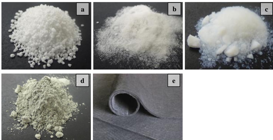
Abbildung 4. Untersuchte Wärmedämmstoffe. (a) gEP; (b) fEP; (c) pKS; (d) SiC; (e) Aerogelmatte /Sta16/
