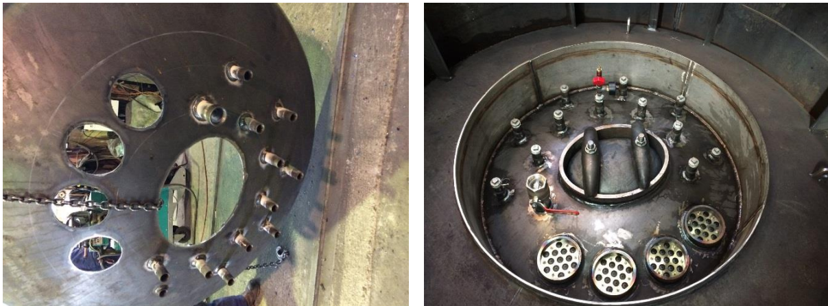
Abbildung 41. Fertigungsvorgang, Herstellung der Anschlussmuffen (links) und fertige Bodengruppe (rechts)
