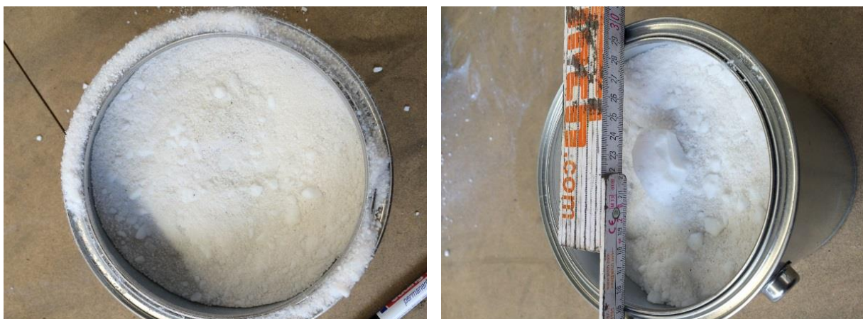
Abbildung 36. Perlit und Kieselsäure ohne Behandlung (links) und Perlit und Kieselsäure nach mechanischer Mischung (rechts)
