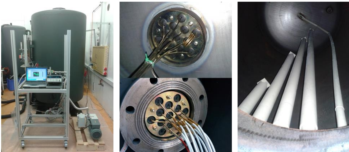
Abbildung 28. Funktionsmuster (Wasservolumen: 1,5 m 3 ) mit aktiver Schichtbe- und Entladeeinrichtung, Messdatenerfassung und Vakuumpumpe am Speicherprüfstand (links); Durchführung der Sensorhülsen der Messsensoren am Boden des Funktionsmusters mit einer Doyma-Dichtung (mittig); Beladelanzen und Entlüftungrohr im Inneren des Funktionsmusters (rechts)
