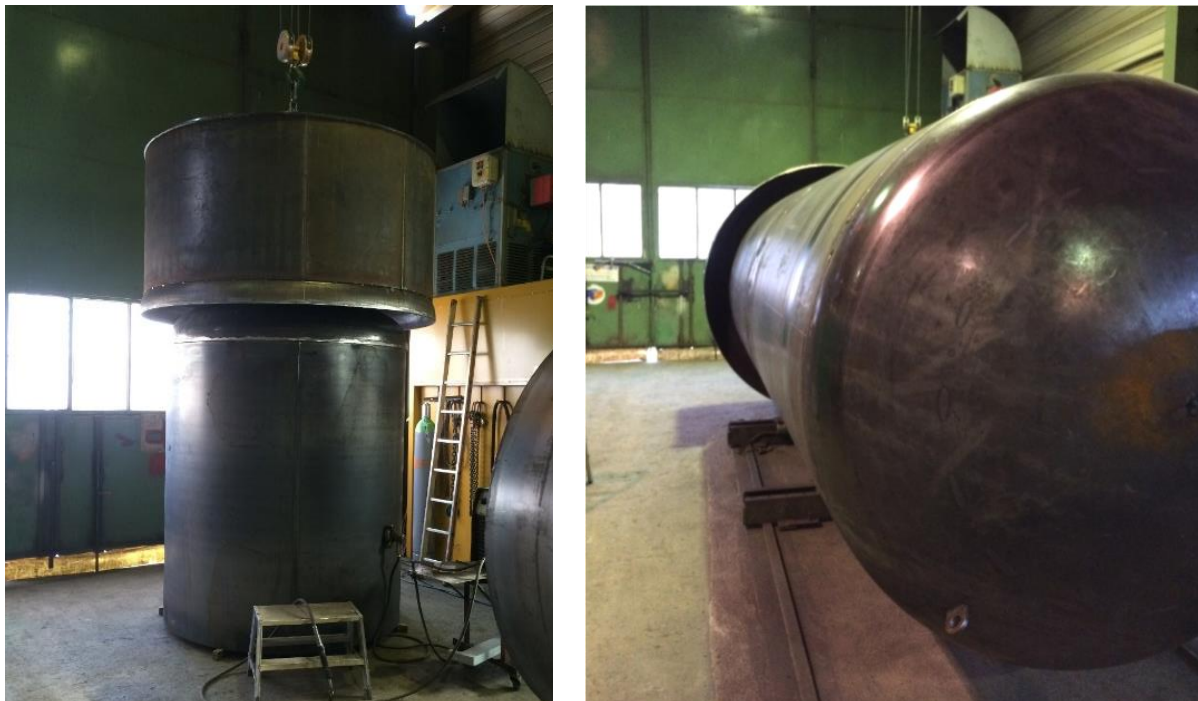
Abbildung 44. Bodengruppe auf Mantelschuss (links) und Bodengruppe mit Innenspeicher (rechts)
