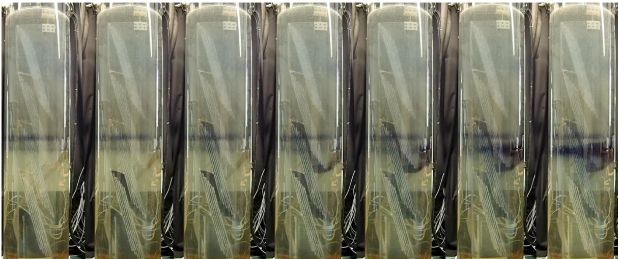
Abbildung 84. Bilderfolge einer Beladefluidmarkierung (Zeitdifferenz zwischen den Bildern: 15 s) während der Einschichtsequenz des Lamellenladers Typ 1 mit einem Volumenstrom von 173 l/h, einer Beladefluidtemperatur von 37 °C und einer geschichteten, anfänglichen Speicherfluidtemperaturverteilung resultierend aus der Beladesequenz in Abbildung 83
