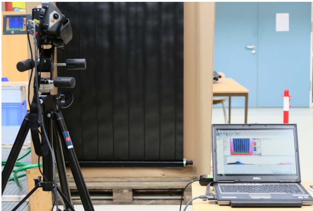
Abbildung 6-4: Untersuchungsaufbau mit der Thermografie-Kamera, dem Auswerterechner und dem mattschwarz lackierten Absorber
