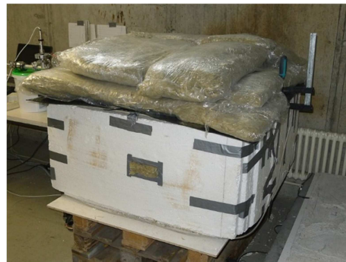
Abbildung 5-10: links: regelbare Heizplatte mit 2000 W Leistung; rechts: Wasserbehälter mit Wärmedämmung aus expandiertem Polystyrol an den Seitenwänden und Mineralwolle auf dem Deckel
