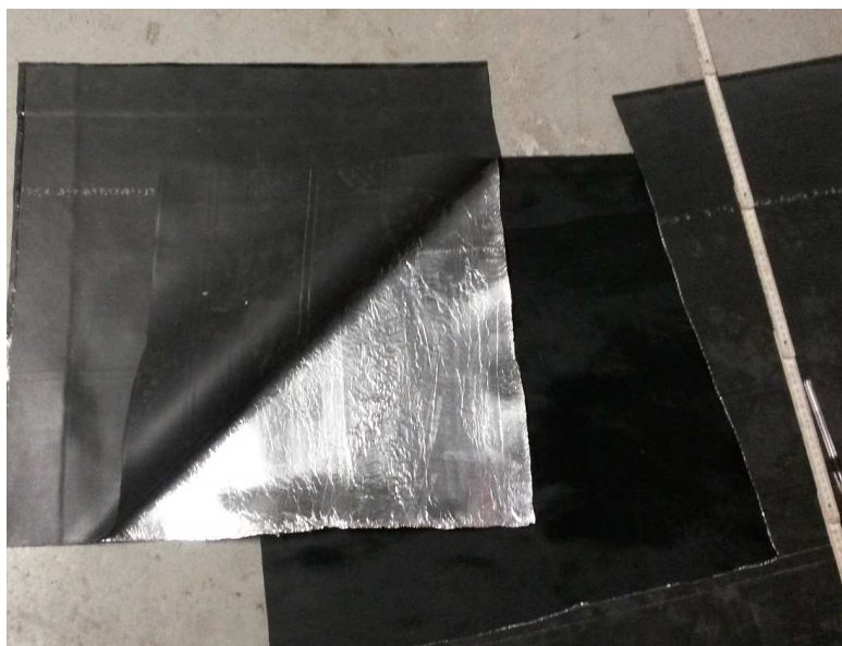
Abbildung 5-5: Auffächerung der Verbundfolie beim Zerschnitt
