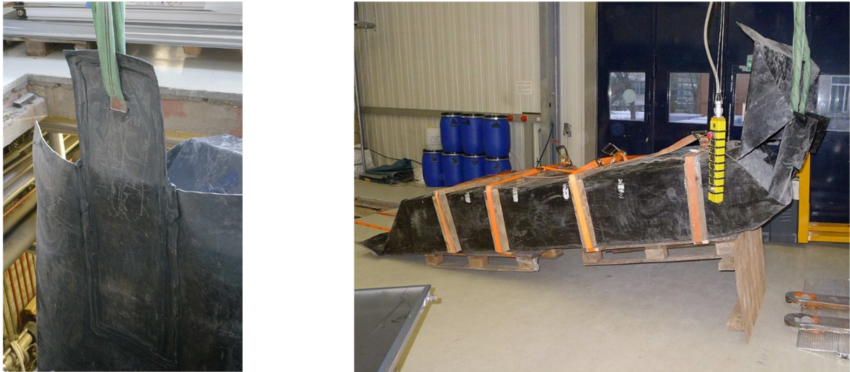
Abbildung 5-18: Links: Lasche zur Befestigung des Prototyps am Kran, rechts: Versteifung des Prototyps mittels Spanngurten und seitlichen Holzlatten während der Befüllung mit SGS
