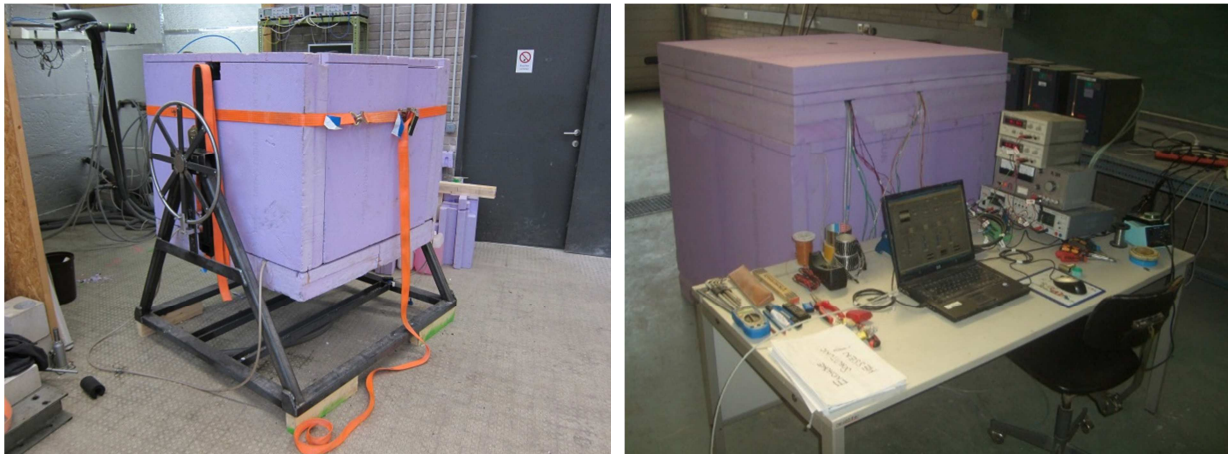
Abbildung 4-33: links: Ein- Plattenapparatur drehbar gelagert; rechts: Messdatenerfassungssystem der Ein-Plattenapparatur. [34]
