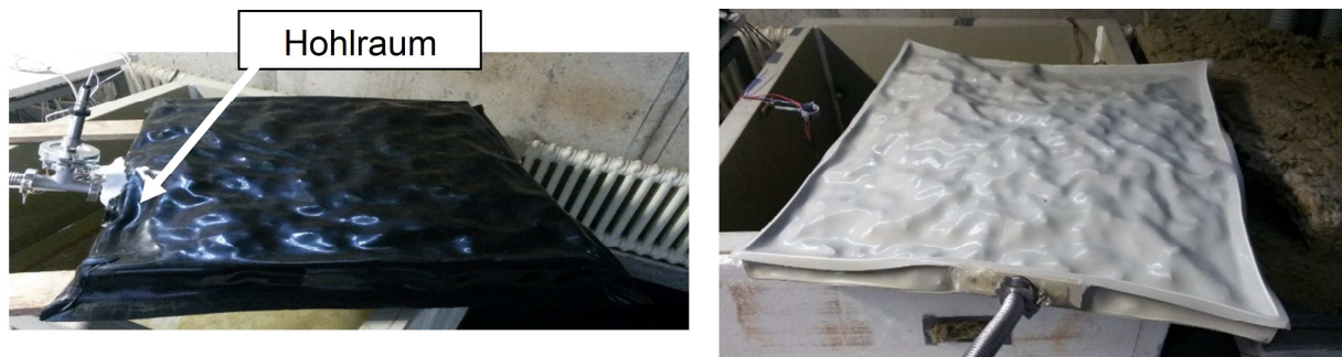
Abbildung 5-9: Oberfläche des PE-HTR Pakets(links) und des PP Pakets (rechts) nach mehreren Evakuierungsvorgängen
