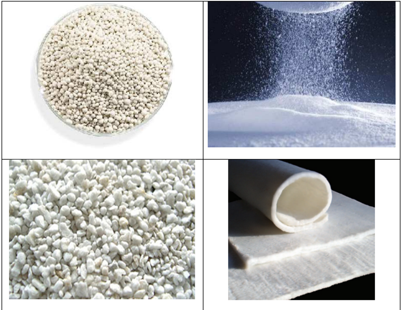
Abbildung 5-7: Links oben: BGG [21], rechts oben: pyrogene Kieselsäure [22], links unten: Perlit [23], rechts unten: Aerogelmatten [24]
