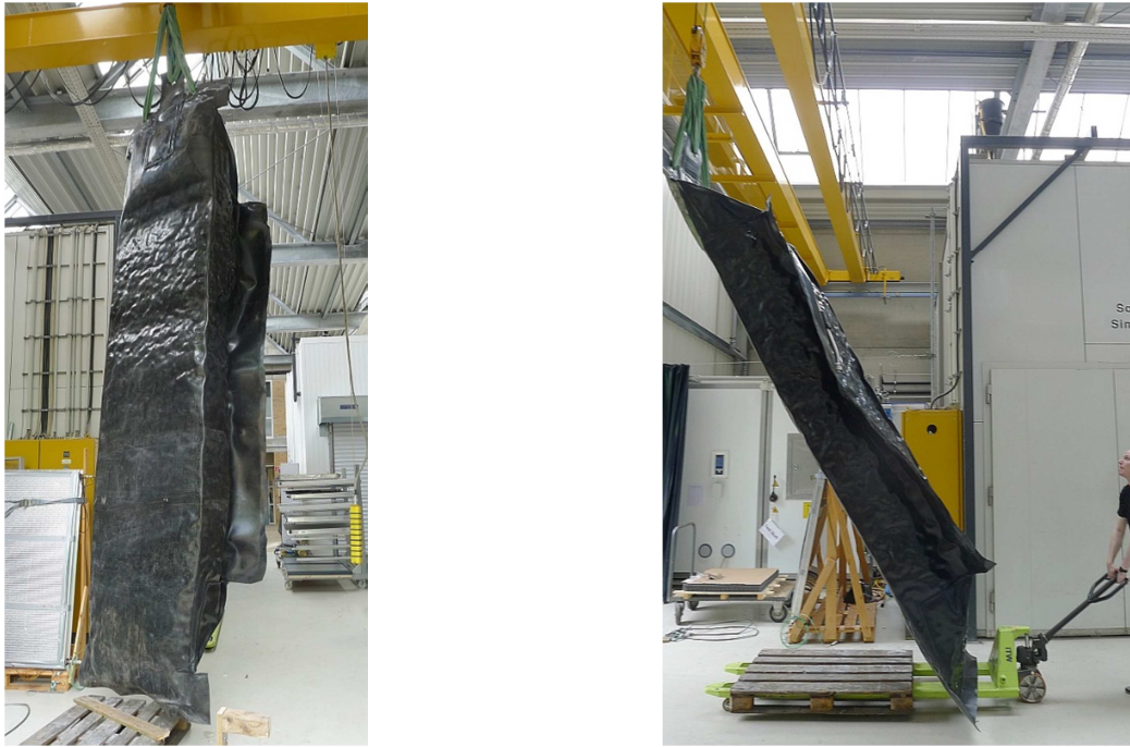
Abbildung 5-21: Links: Der Prototyp schwebt im evakuierten Zustand frei an der Kranaufhängung, rechts: kontrolliertes Herablassen des Prototypen mithilfe eines Hubwagens
