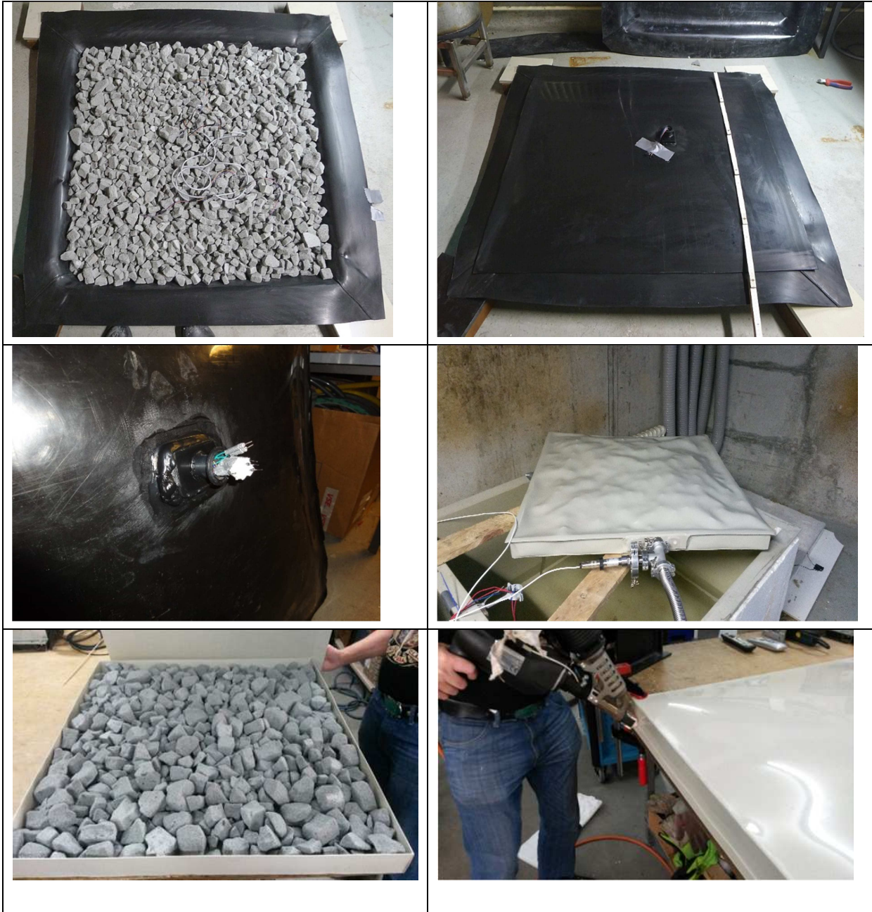
Abbildung 5-8: links oben: PE-HTR Behälter gefüllt mit SGS 10/25; rechts oben: PE-HTR Behälter kurz vor anschweißen des Deckels; mitte links: angeschweißter ISO-KF DN25 Flansch aus Kunststoff und Kabel zum Anschluss der Feuchtigkeitssensoren; mitte rechts: evakuierter PP Behälter, Anschluß des Drucksensors über ein T-Stück; unten links: PP-Behälter befüllt mit SGS 10/75; rechts unten: Herstellung des PP Behälters mittels Extrusionsschweißgerät
