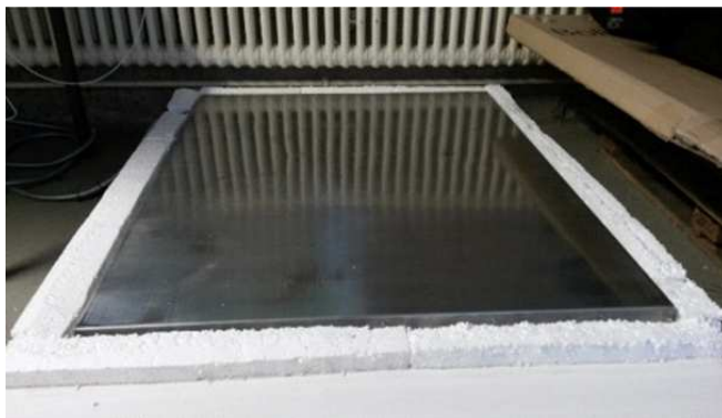
Abbildung 5-10: links: regelbare Heizplatte mit 2000 W Leistung; rechts: Wasserbehälter mit Wärmedämmung aus expandiertem Polystyrol an den Seitenwänden und Mineralwolle auf dem Deckel
