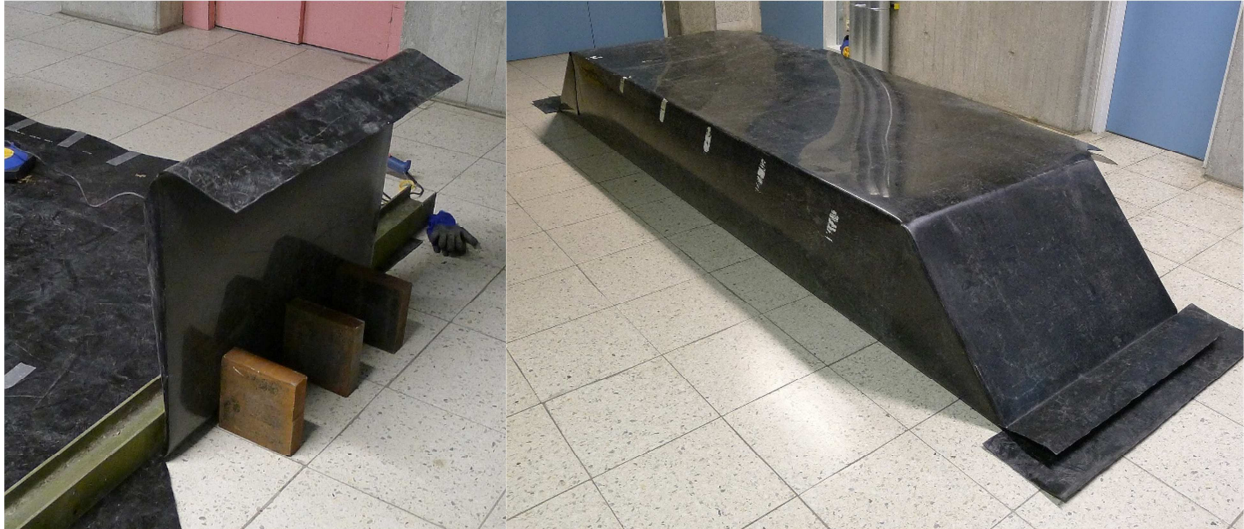
Abbildung 5-17: Links: Biegung der Kanten mit Gewichten und T-Stahlträger in einem 90° Winkel, rechts: Der fertig gebogene Prototyp behält ohne Schweißnaht seine Form
