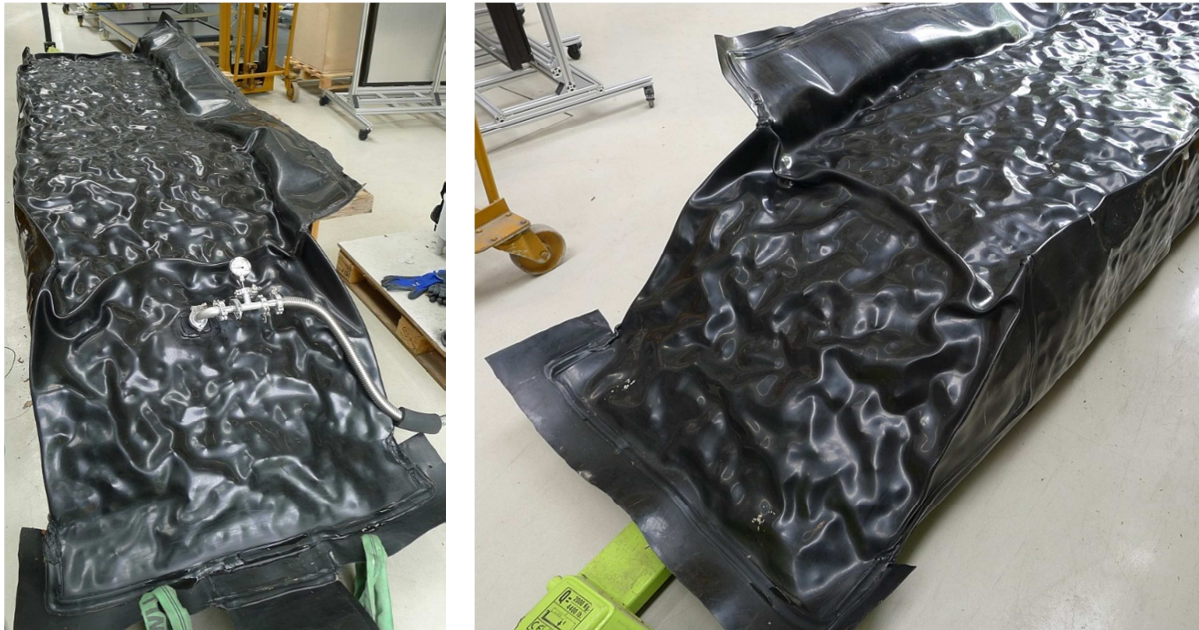
Abbildung 5-20: Verformungen des Prototyps infolge der Evakuierung mittels Vakuumpumpe auf einen Druck von 30 mbar
