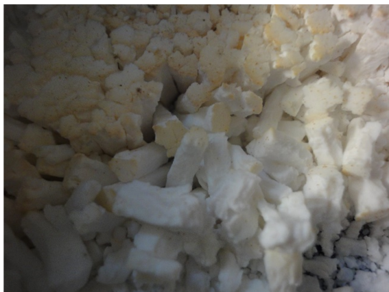
Abbildung 5-13: PKS nach Evakuierung und Exposition im Wasserbad
