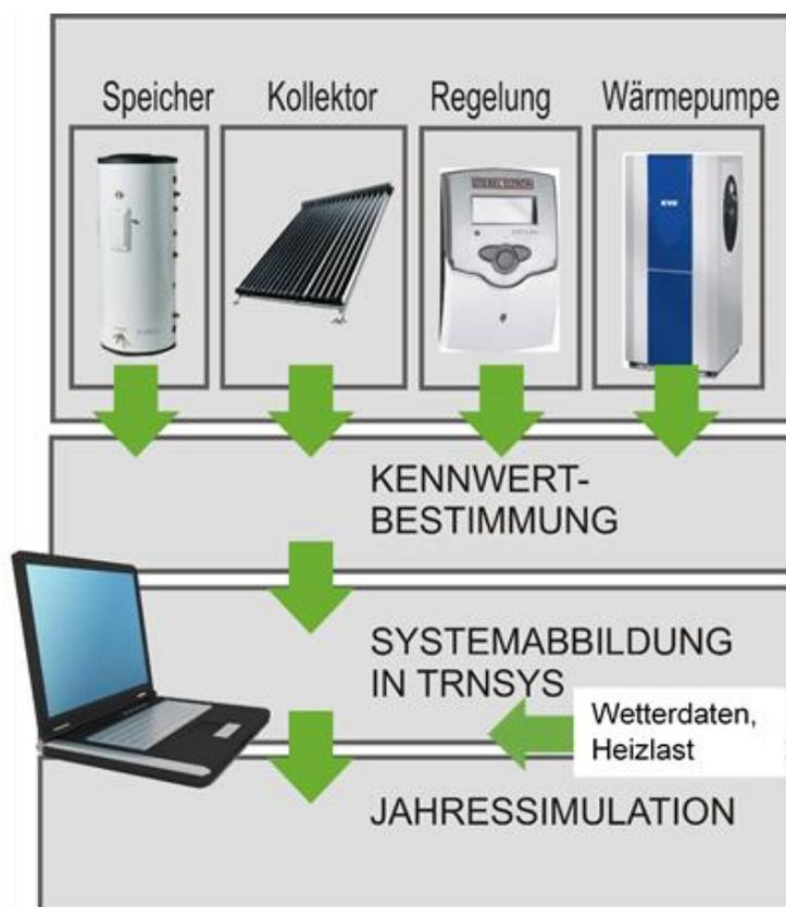
**Abb. 2.4:** *Prinzipieller Ablauf des erweiterten CTSS-Prüfverfahrens für Solarthermie-Wärmepumpenanlagen*
