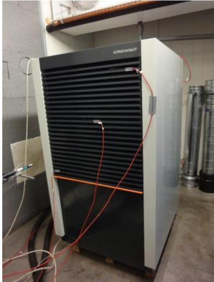
*Abb. 4.14: Luft/Wasser-Wärmepumpe in der Klimakammer zur Prüfung*
