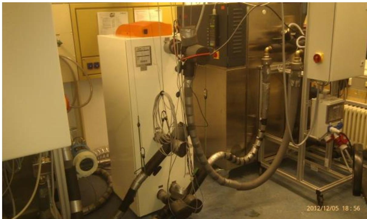
**Abb. 4.2:** Aufbau der Sole/Wasser-Wärmepumpe im Wärmepumpenprüfstand
