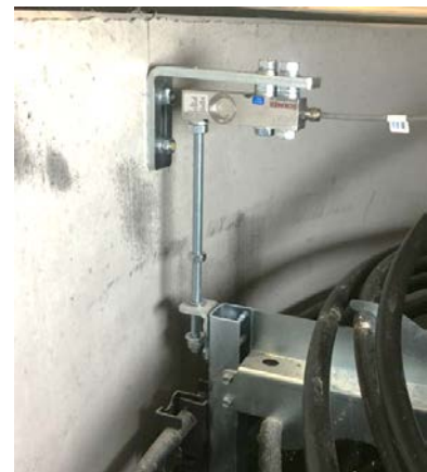
Abb. 13: links: Kranwaage zur direkten Bestimmung der wahren Eismasse am Ende der Entzugsphase rechts: Kraftsensoren (Sensor F) zur kontinuierlichen, indirekten Bestimmung der Eismasse während der Be- und Entladung
