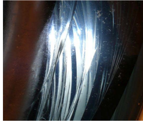
Abb. 23: Kristallklares Eis ohne Lufteinschlüsse am Anfang der Entzugsphase beim 2. Vorversuch
