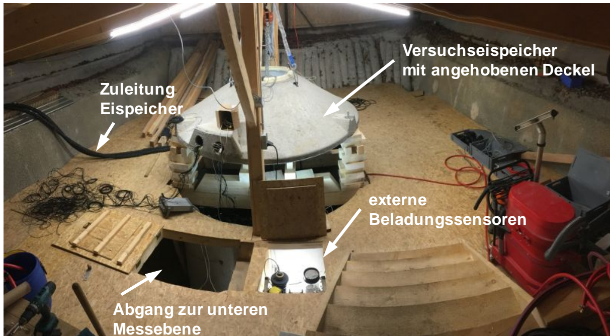
Abb. 12: Versuchseispeicher mit angehobenem Speicherdeckel und umgebender Arbeitsplattform sowie Zugang zu den extern angebrachten Beladungssensoren
