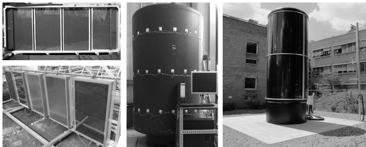
Abbildung 3.1: Versuchsstände im Labor- (links), Technikums- (mittig) und Realmaßstab (rechts) zur Untersuchung transparenter Wärmedämmungen und hoch-effizienter Warmwasserspeicher mit Vakuumwärmedämmung.
