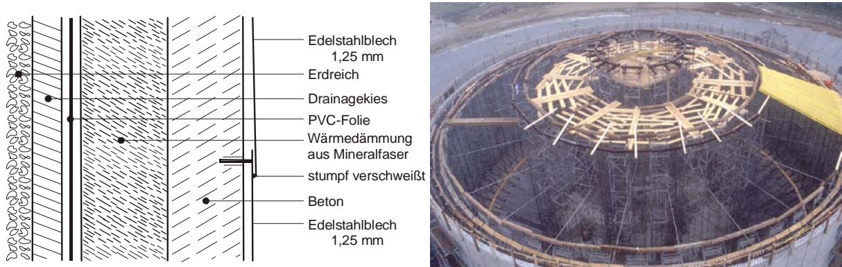
Bild 7: Aufbau der Speicherwand und Speicher im Bau (Projekt Friedrichshafen)
