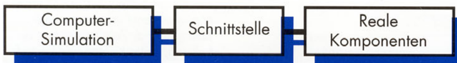
Bild 3: Prinzipielle Darstellung eines Emulators.
