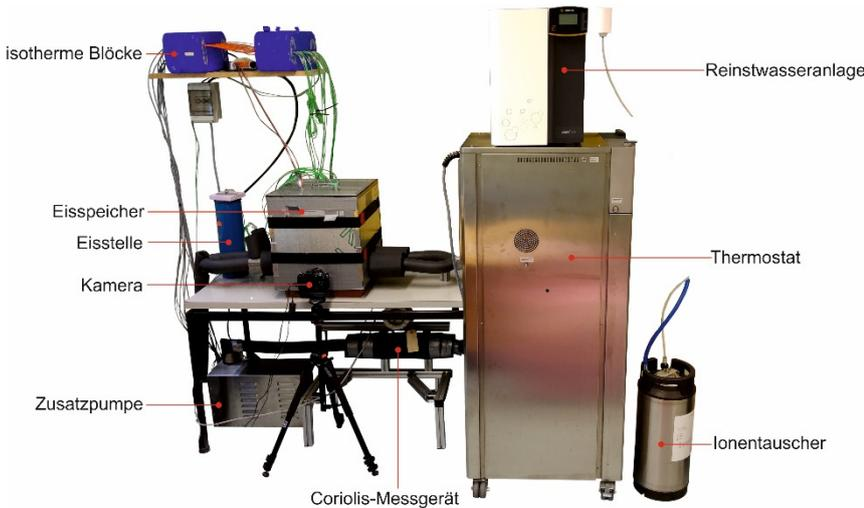
**Bild 5: Eisspeicher-Versuchsstand**
