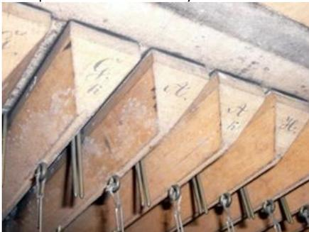
**Bild 1: Schimmelpilzbefall an Tonventilen**
