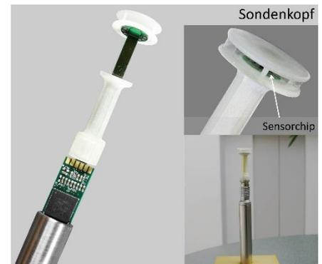
Bild 1: Zweidimensionaler Strömungssensor (Kopfdurchmesser 15 mm)
