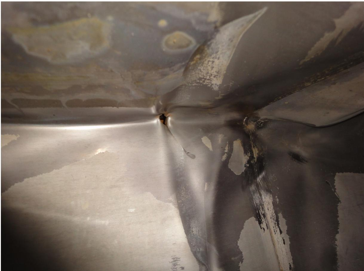
**Abb. 57: Leckage im 100 Pufferspeicher bei der Inbetriebnahme der Wärmepumpe**
