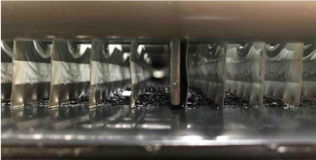
Abbildung 10: Wärmeübertragerlamellen mit ausgewähltem Kleber auf Rückseite des PV-Moduls (unten) geklebt.
