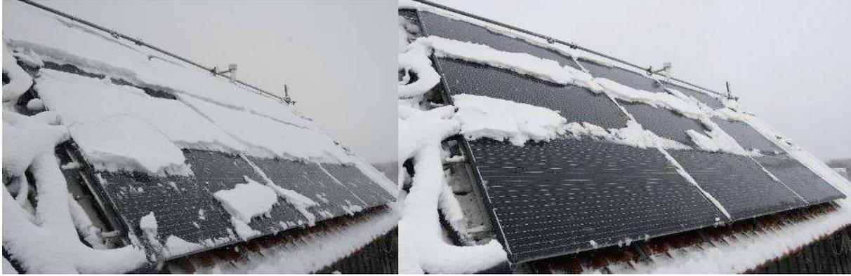
Abbildung 43: Schneeabrutschverhalten am PVT-Kollektorfeld mit Lochblechen (Konfiguration C2).
