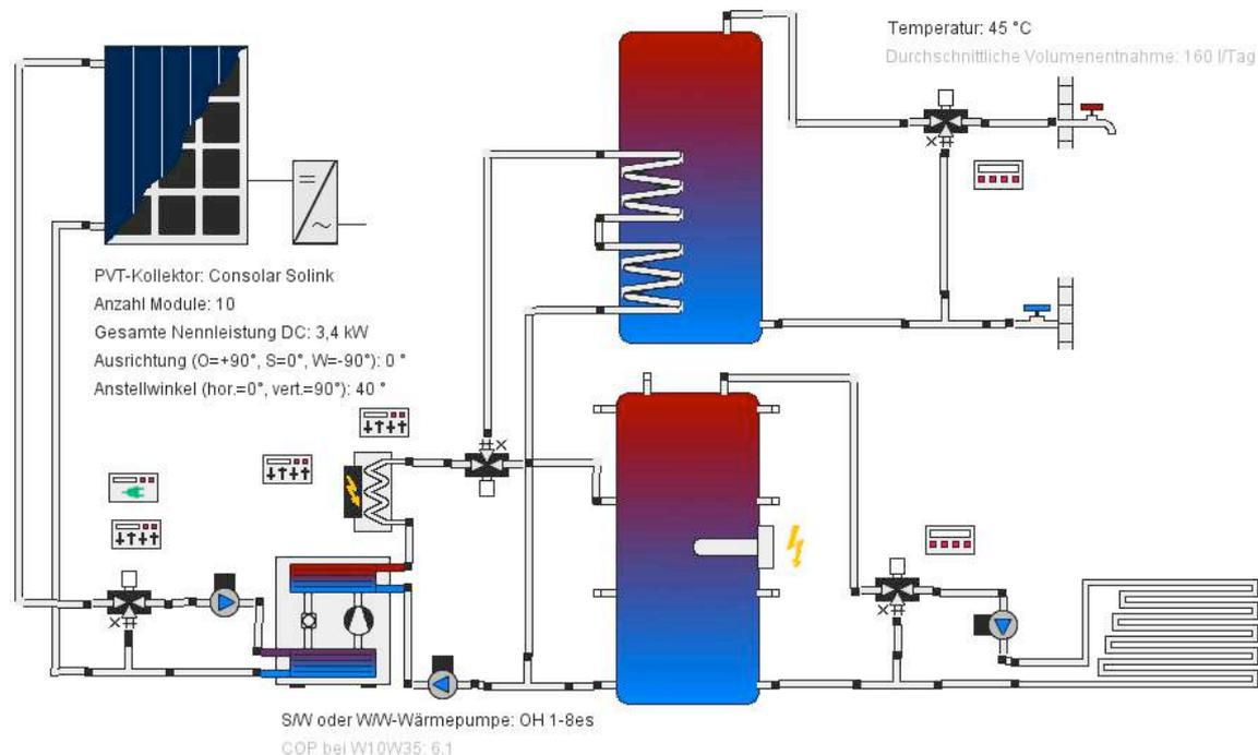
Abbildung 69: Polysun-Anlagenschema der Simulationsvariante B (TW-Speicher + Puffer).
