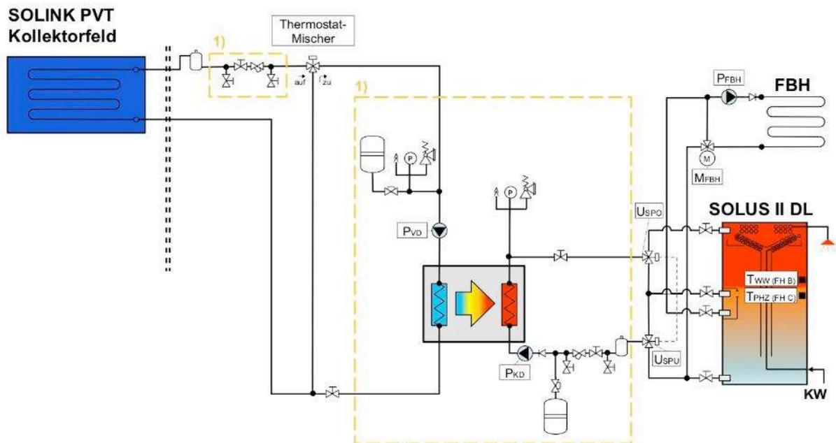
Abbildung 3: Hydraulikschema einer SOLINK-Anlage mit thermostatischem Mischventil und allen notwendigen Armaturen. 1) = Typischer Lieferumfang des Wärmepumpenanbieters
