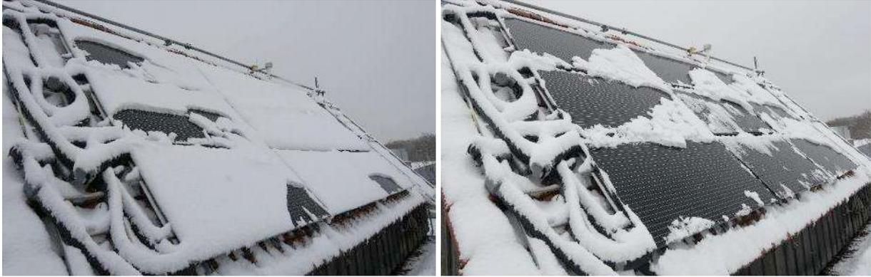
Abbildung 41: Schneeabrutschverhalten am PVT-Kollektorfeld ohne Lochbleche (Konfiguration B).
