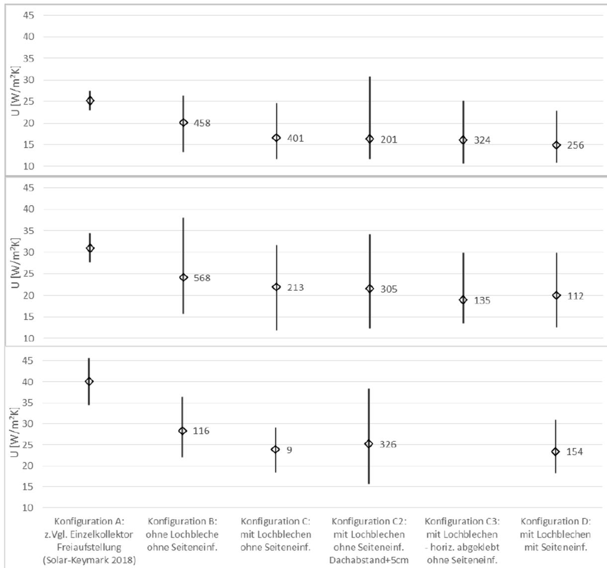
Abbildung 38: Wertebereich der Messpunkte zur Untersuchung des Einflusses von Spaltabdeckungen (Lochblechen) zwischen den Kollektoren sowie einer Seiteneinfassung auf das Wärmeübertragungsvermögen  $U$  des PVT-Kollektorfelds zur Umgebung, bei einem übertragenen Wärmestrom von 100 – 250  $W/m^2$  und unterschiedlichen Windverhältnissen:
