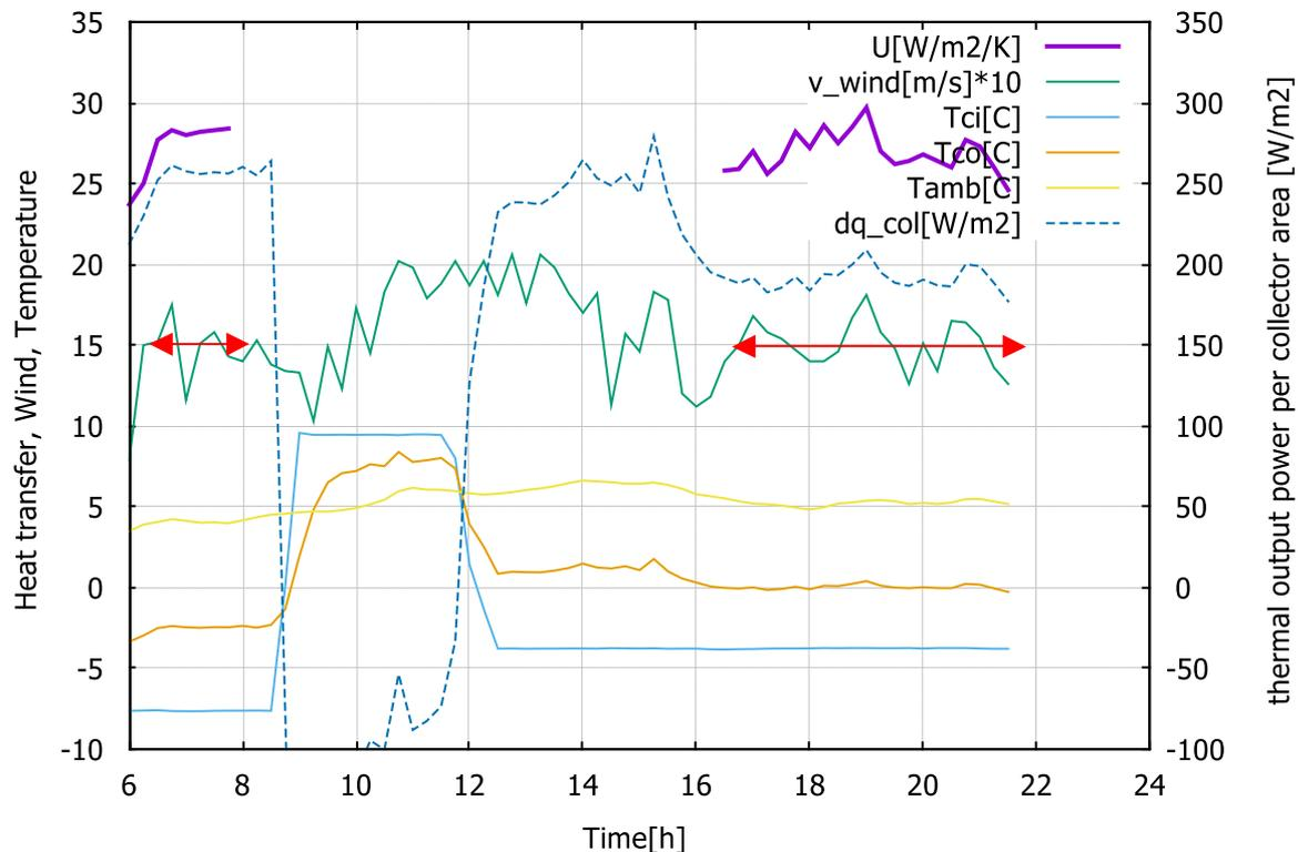
*Abbildung 82: Messdaten (15min-Mittelwerte) und berechneter U-Wert zur Umgebung vor und nach der Kollektorenteisung (9 - 12 Uhr) am 20.12.2018; U-Wert-Berechnung erfolgt nur zu Zeiten ohne Einstrahlung (vor 8:00 bzw. nach 16:00); Zeiträume mit vergleichbarer Windgeschwindigkeit sind rot markiert*
