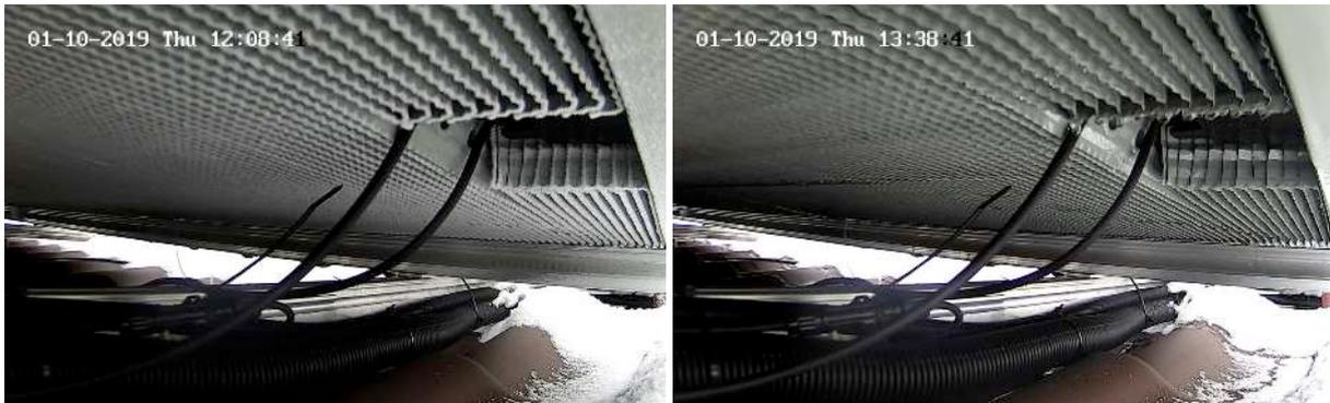
Abbildung 78: Bilder von Kamera 2 im Zwischenraum zwischen Dach und Wärmeübertrager des PVT-Kollektors zur Analyse des Kondensations- und Vereisungsverhaltens der **Feldtestanlage Korb**: Wärmeübertrager-Lamellen vor (Bild links) und nach (Bild rechts) Betrieb der Schneeabrutsch- und Enteisungsfunktion.
