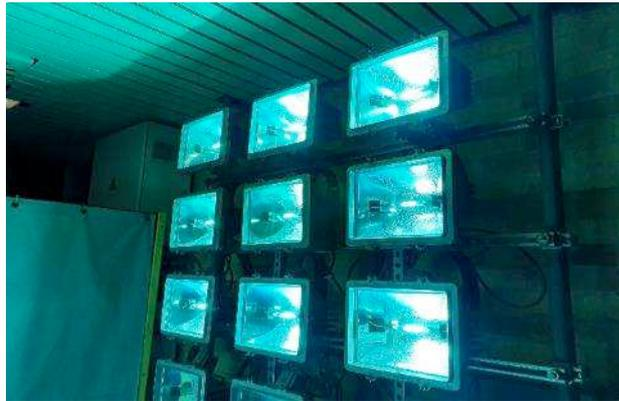
Abbildung 13: PVT-Kollektor in der UV-Prüfung
