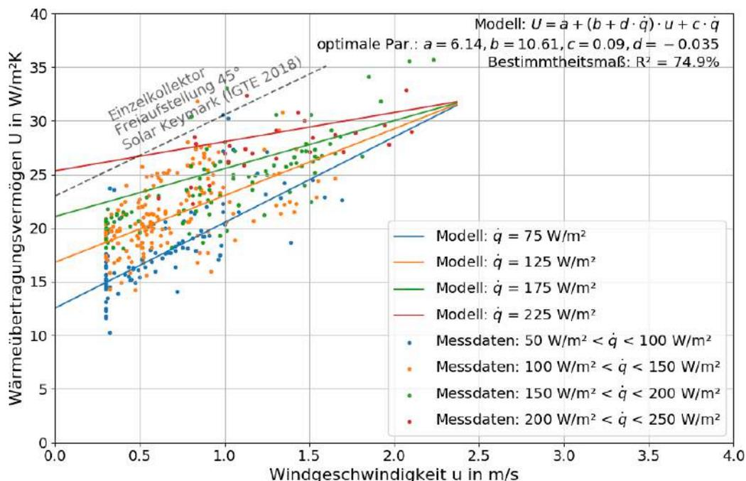
*Abbildung 39: Messdaten und Parameteridentifikation (lineares Modell) für den Wärmeübergang, hier am PVT-Kollektorfeld ohne Lochbleche (Konfiguration B): Wärmeübertragungsvermögen  $U$  zur Umgebung in Abhängigkeit von Windgeschwindigkeit ( $u$ ) in Kollektorebene und übertragenem Wärmestrom  $\dot{q}$*
