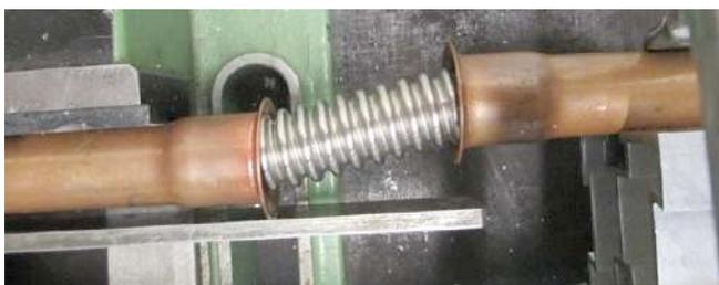
Abbildung 30: Kollektorverbinder im Dauertest bei extremem Versatz
