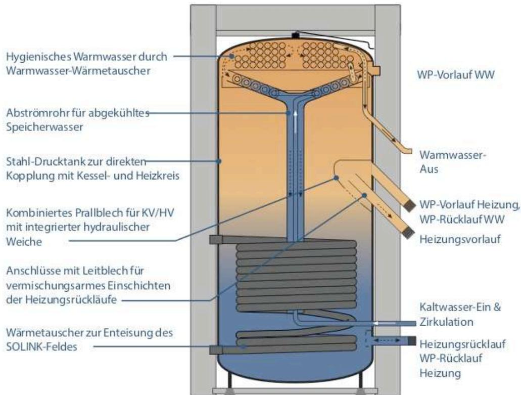
Abbildung 4: SOLUS-Kombispeicher mit integriertem Glattrohr-Wärmeübertrager zum Wärmeentzug für Schneentauen, Enteisung und Rückkühlen (Gebäudekühlen) sowie zur solaren Direktbeladung
