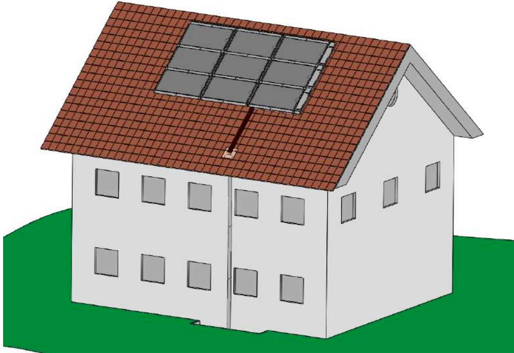
*Abbildung 51: Die Sammleranschlüsse sind rechts unter Abdeckblechen an deren Haltern montiert, die beiden Leitungen sind unterhalb des unteren Abdeckblechs horizontal verlegt und werden dann unterhalb eines Abdeckblechs bis zu einer Dachdurchführung auf dem Dach nach unten geführt. Entlang der Fassade verlaufen die ungedämmten Leitungen innerhalb eines Regenwasserfallrohs und werden in einem Schacht in den Keller geführt.*
