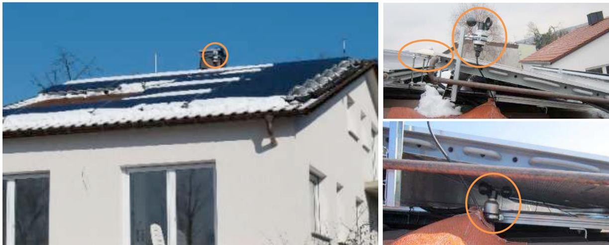
Abbildung 74: Messtechnik zur wissenschaftlichen Überwachung der Feldtestanlage in Korb (Stuttgart): Kamera 1 für Zustand der Kollektoroberfläche (links), Pyranometer und Windsensor in Kollektorebene (rechts oben) sowie Windsensor unterhalb des Kollektor-Wärmeübertragers (rechts unten).
