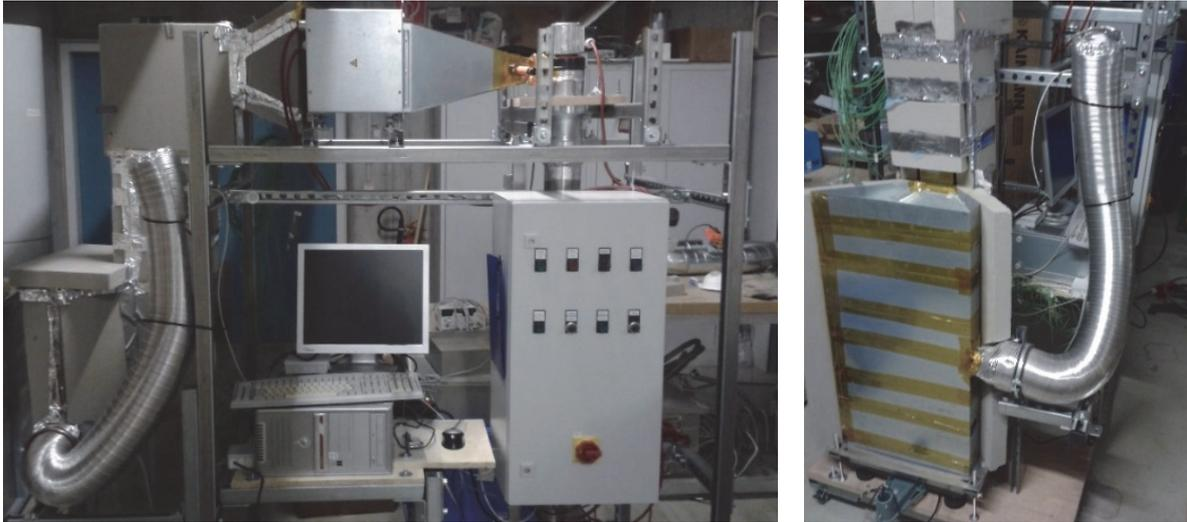
Abbildung 14: Laboranlage mit segmentiertem Sorptionswärmespeicher im verkleinerten Maßstab
