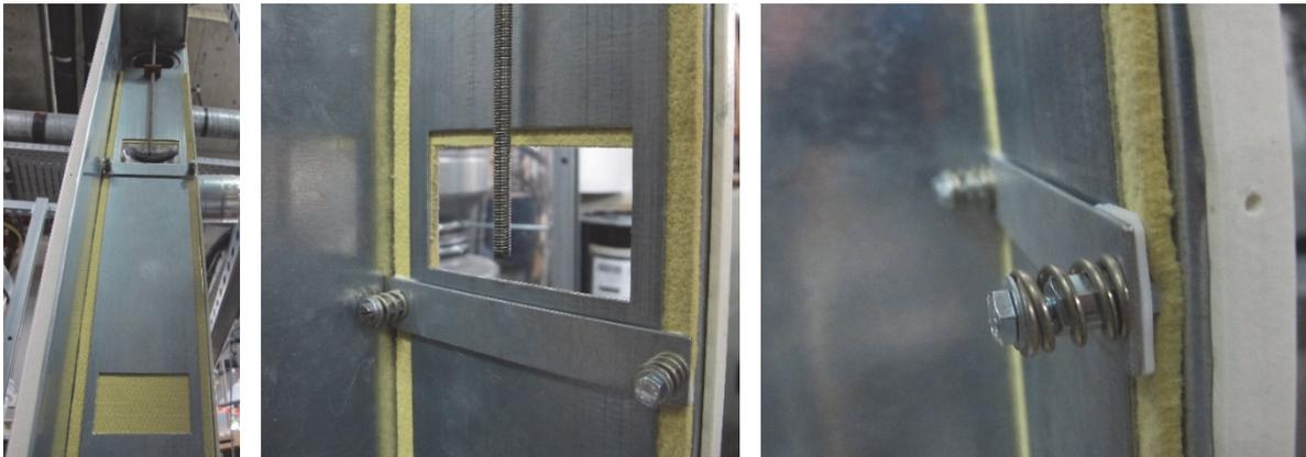
Abbildung 24: Schiebermodell zur Schaltung der Segmente (Mechanismus zur Realisierung der segmentpaarweisen Speicherdurchströmung)
