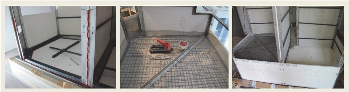
Abbildung 40: Montage der Seitenwände, Einsetzen der Segmentböden, Befüllung mit Zeolith
