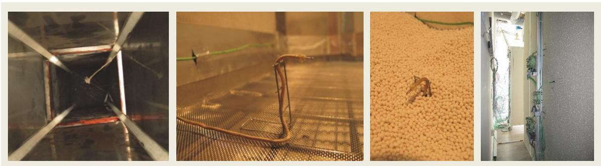
Abbildung 46: Temperaturmessung im Sorptionswärmespeicher; Eintrittskanal (links), Segmente (Mitte), Kabeldurchführung nach Außen (rechts)
