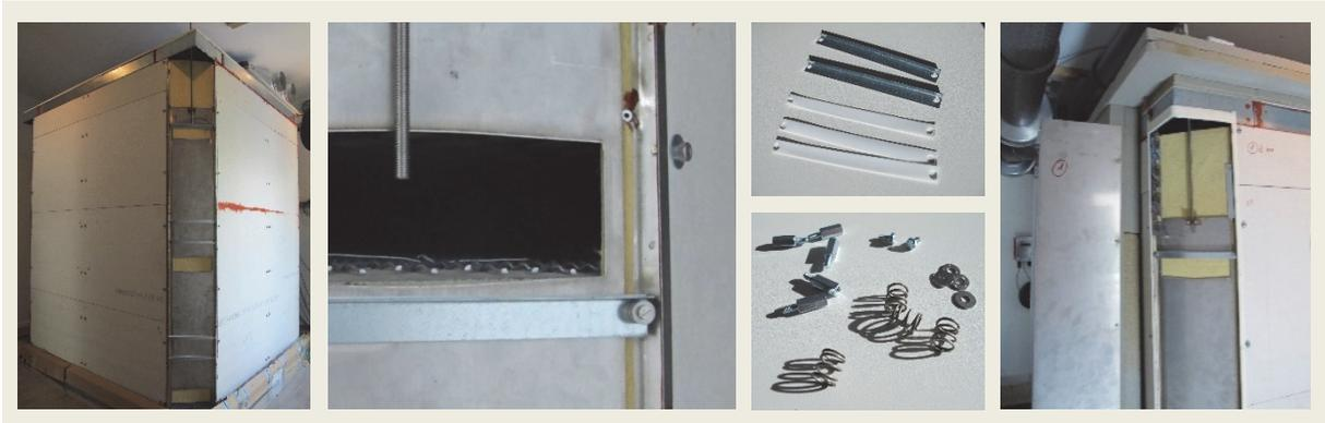
Abbildung 42: Luftkanal entlang der horizontalen Kanten der Speicheroberseite, Anpressen der Schieber mit Federn, Winkelblech vor einer Speicherkante
