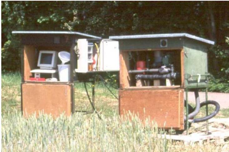
**Bild 4.35: Thermal Response Test in Attenkirchen**
