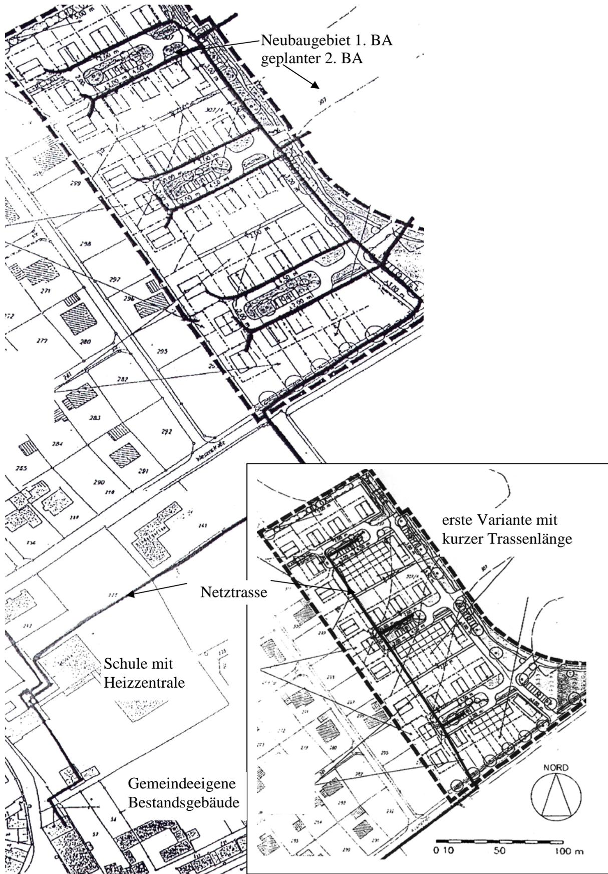
**Bild 2.85:** Lageplan des Neubaugebietes mit eingezeichneten Trassen des Nahwärmenetzes.
