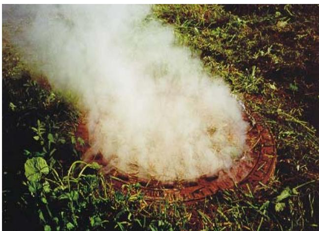
**Bild 4.5: Visualisierte Luftströmung aus Schacht 1**
