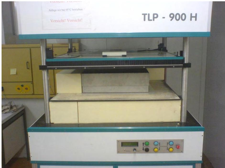
**Bild 45: Probeaufnahmebehälter für Schaumglasschotterschüttungen**
