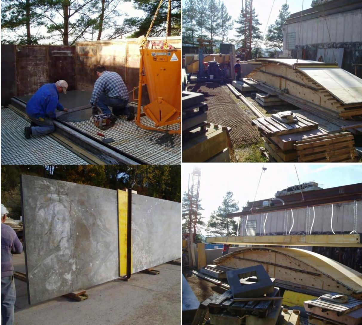
**Bild 160:** Die Sandwichelemente werden aus Hochleistungsfaserfeinkornbeton gefertigt. Der Beton wird auf die PUR/PIR Wärmedämmung aufgebracht.
