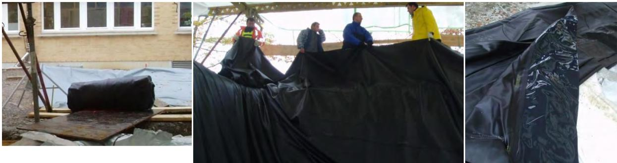
**Bild 15: EPDM im Außenlabor: Links, Lieferung als vorgefertigte Plane, Mitte: ausbreiten im Außenlabor, rechts Fügerand mit dem das Verschweißen ermöglicht wird.**
