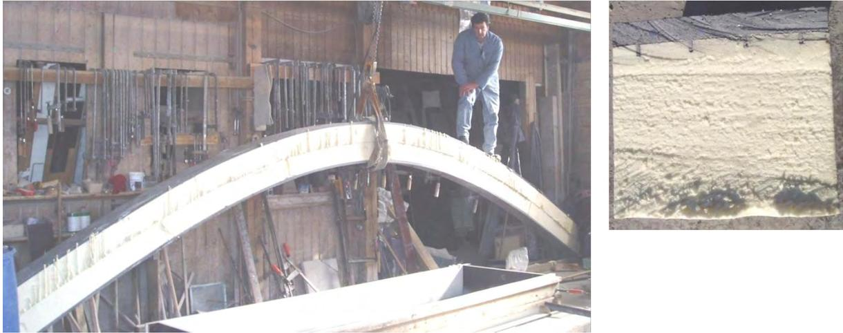
**Bild 159: Prototyp des Sandwich-Fertigteils, gefertigt aus zwei Teilen mit je 2 cm HL-Beton und 16 cm PUR-Dämmung**
