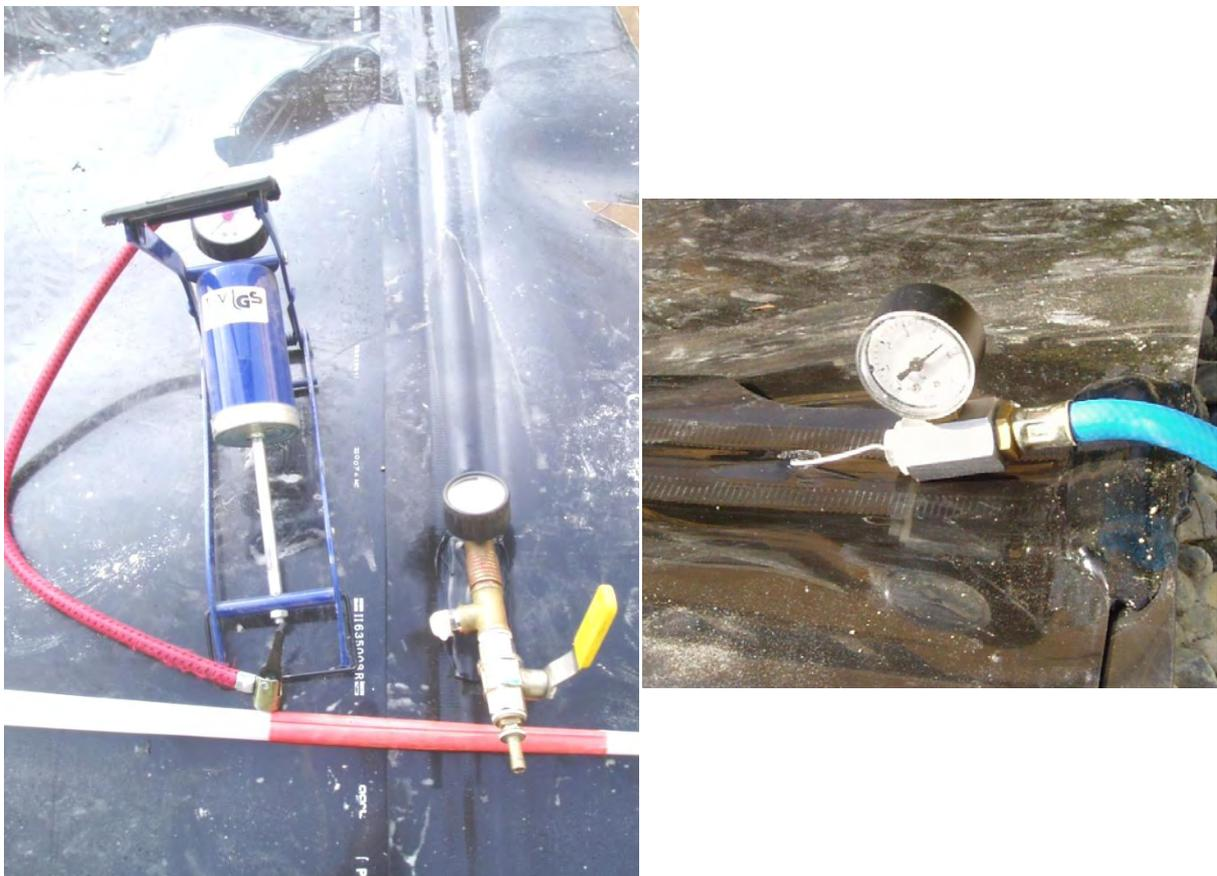
**Bild 108: Druckluftprüfung ist sehr effektiv, da die Schweißnaht über die gesamte Länge geprüft werden kann**
