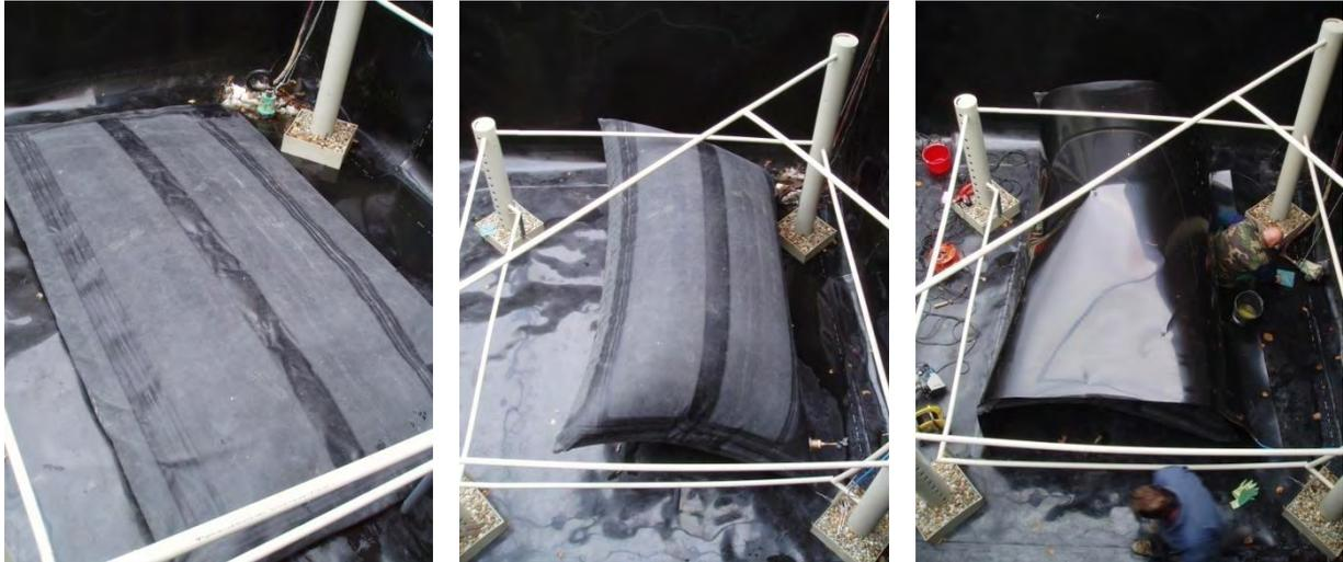
**Bild 179: Membranausdehnungsbehälter für Außenlaborversuch, links: leer, mitte: luftgefüllt und rechts: Befestigung durch Verschweißen einer Kunststoffdichtungsbahn**
