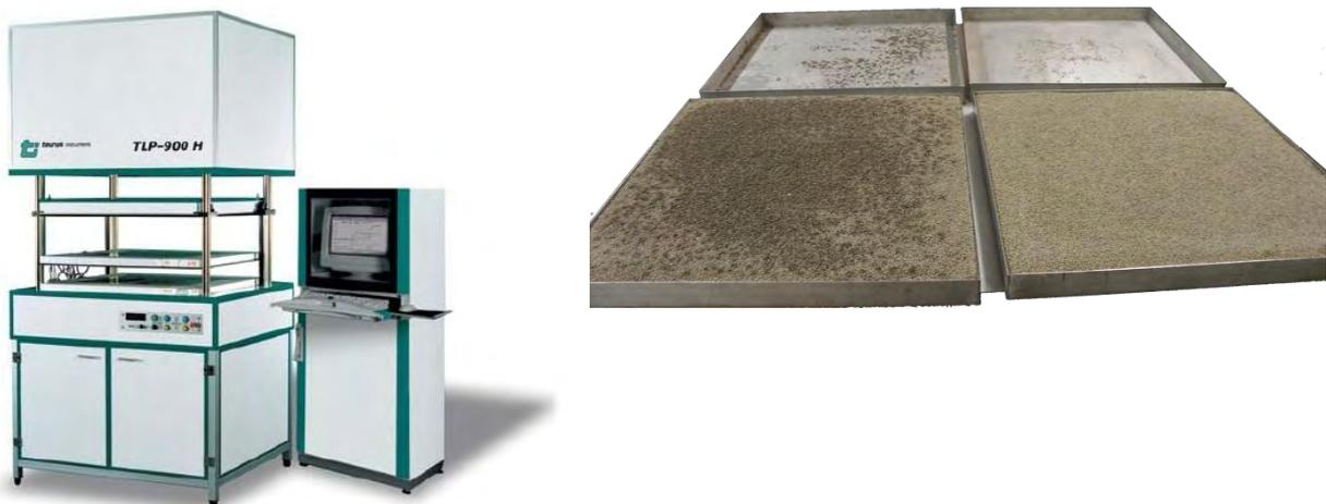
**Bild 43: Zwei-Platten-Apparatur des Herstellers Taurus Instruments am ITW (links) Foto der Probenaufnahmebehälter gefüllt mit Blähglasgranulat (rechts)**
