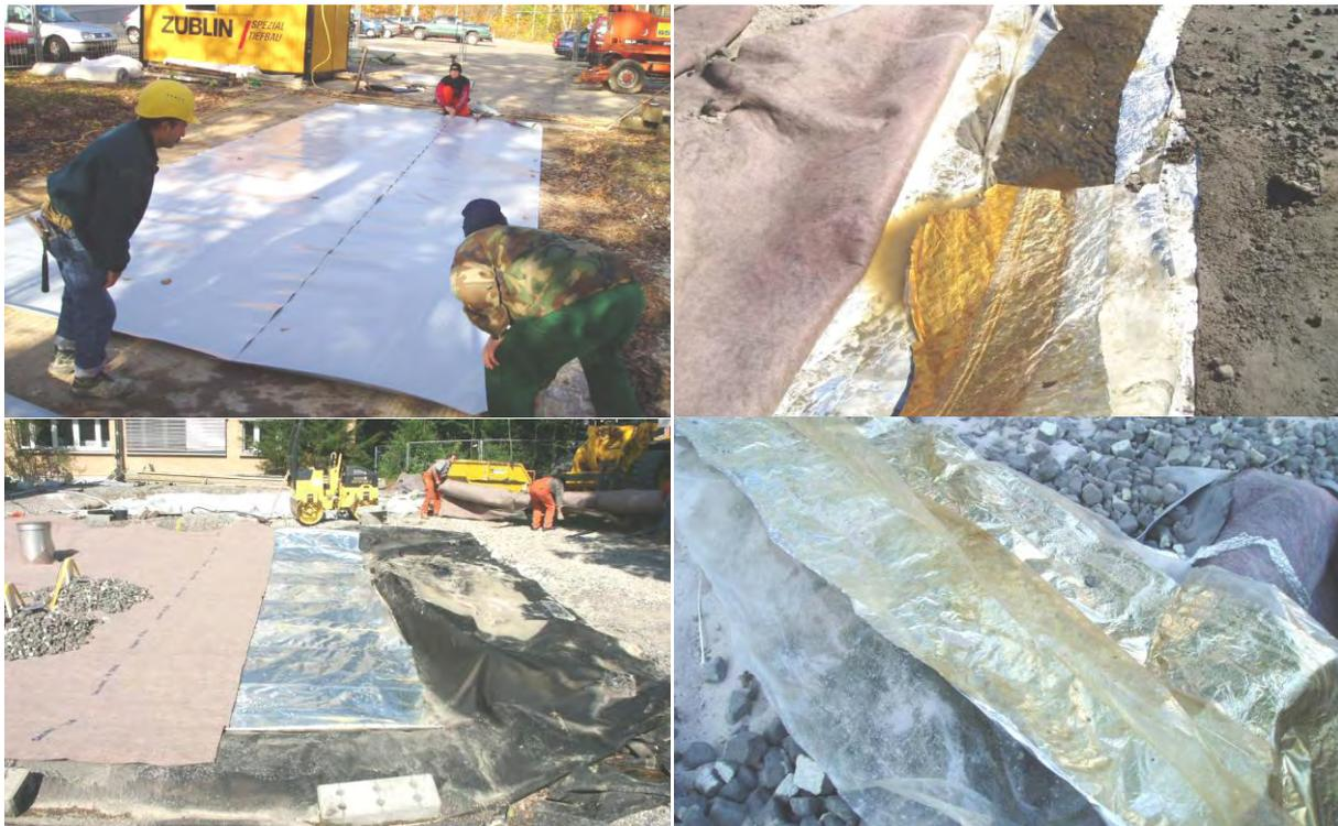
**Bild 111: Degradation einer Dampfsperre nach weniger als ein Jahr Betrieb (Bilder rechts). Die einzelnen Schichten lösen sich voneinander ab. Die Aluminiumschicht ist nicht mehr vor Korrosion geschützt.**
