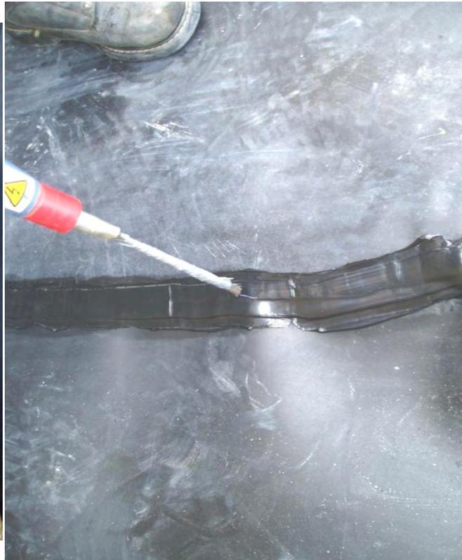
**Bild 109: Dichtigkeitsprüfung mittels Saugglocke (links), für das Funkenprüfverfahren wird beim Schweißen ein Prüfdraht in die Extrusionsschweißnaht eingebracht**
