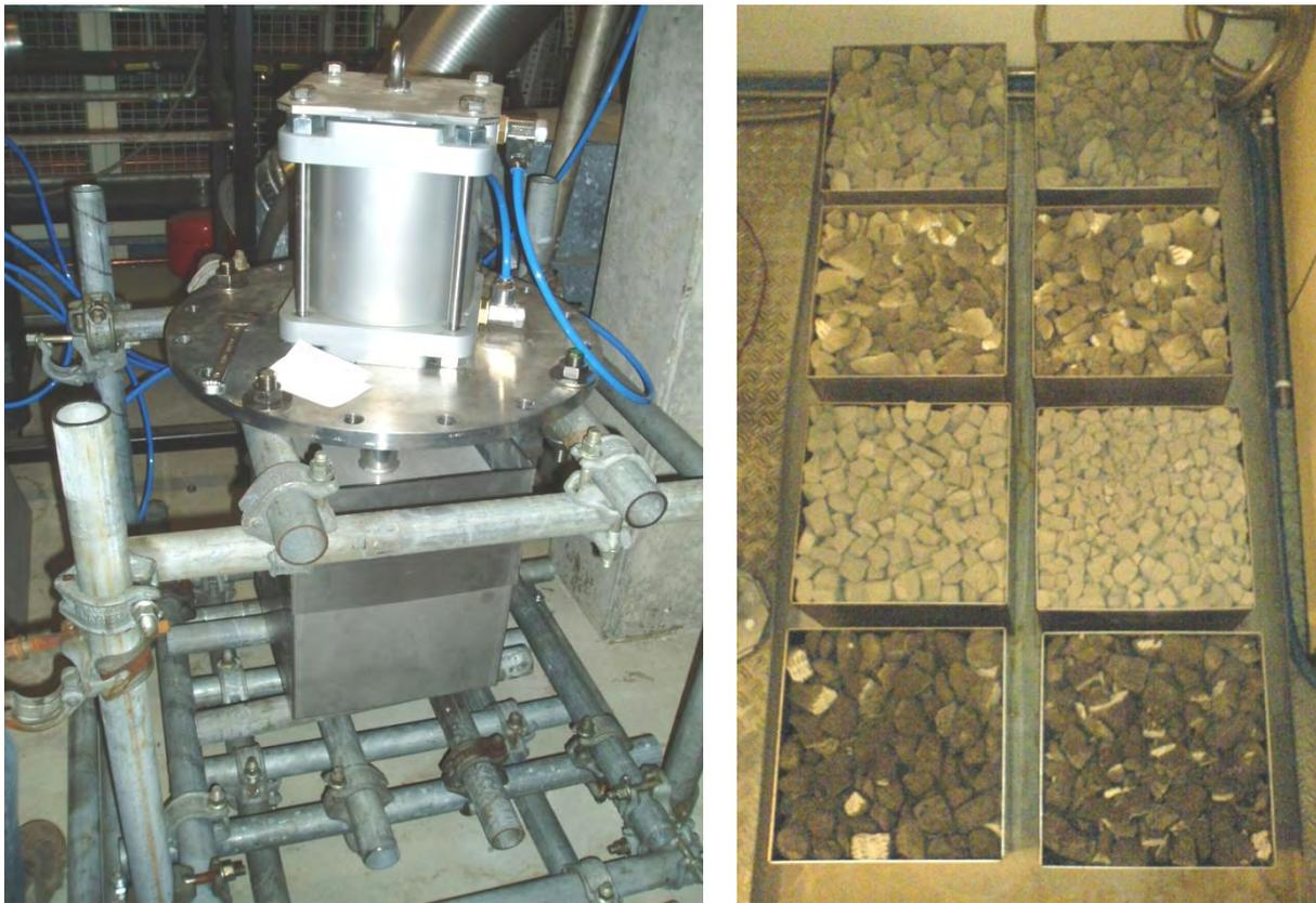
**Bild 57: Verdichtungseinheit (links) und verdichtete Proben in Behältern aus VA für Wasseraufnahme- und Trocknungsversuche**
