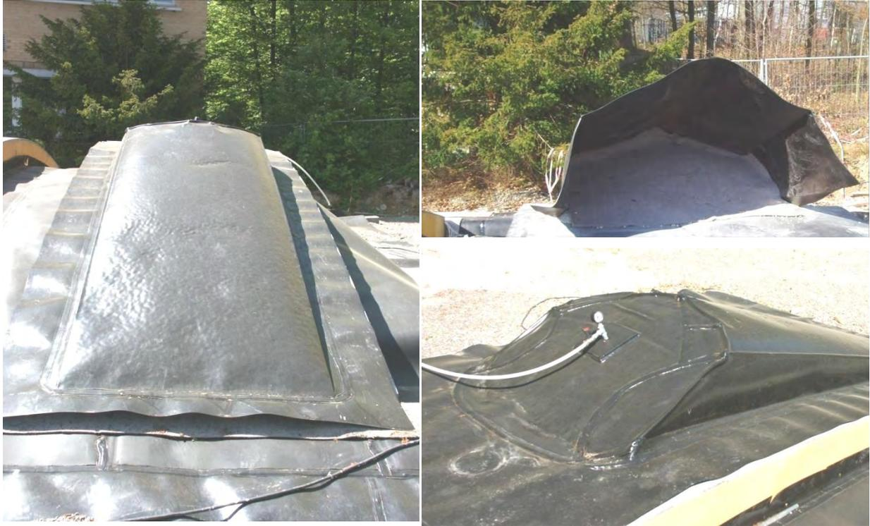
**Bild 93: Evakuierung dämmstoffgefüllter Kammern, Vorversuch im Außenlabor**
