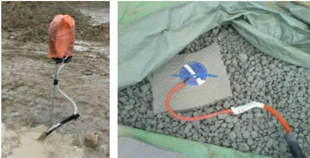
**Bild 3.1-17: Messlanze (links) und Wärmestrom-Messplatte (rechts) am Erdsonden-Wärmespeicher**
