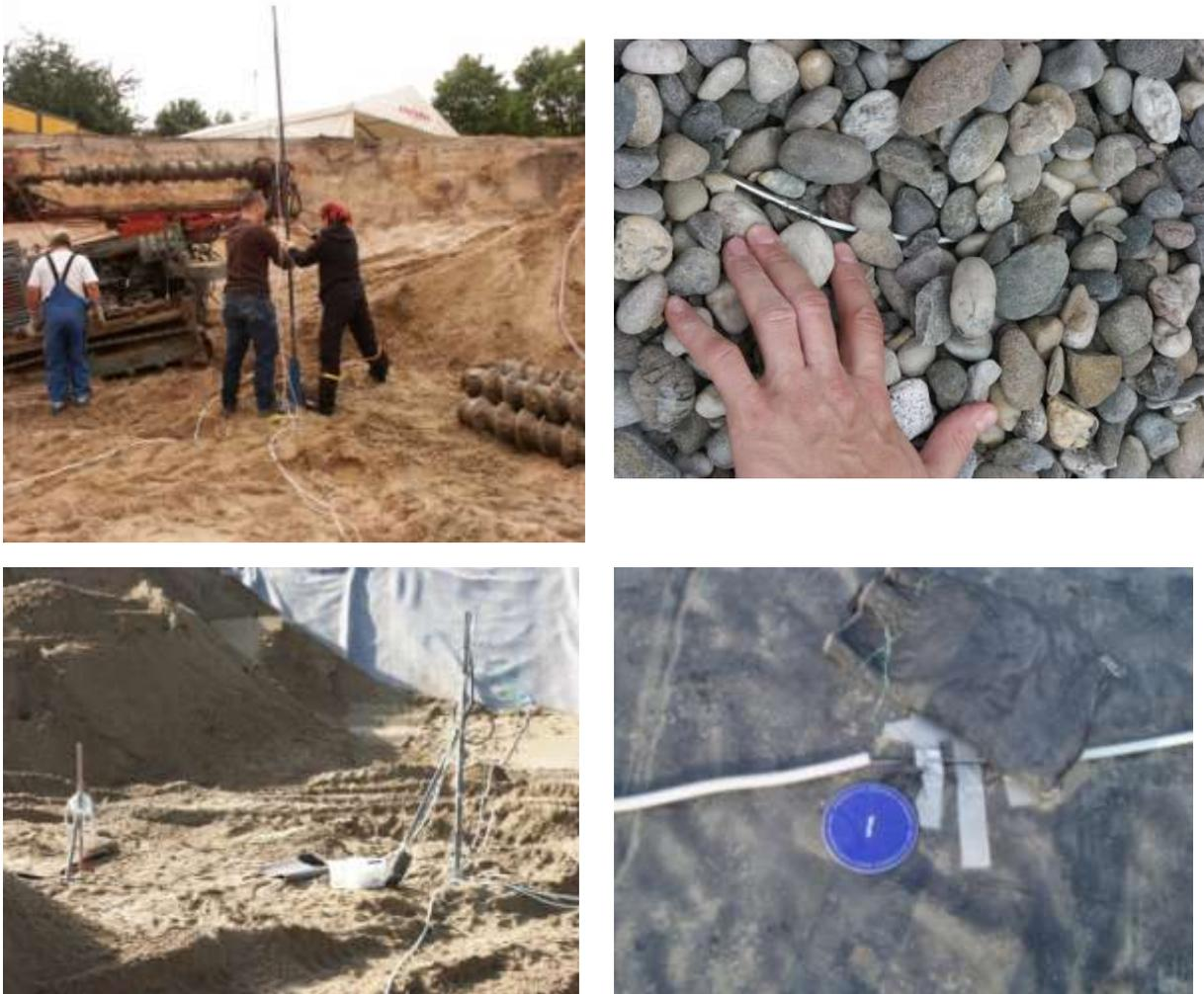
**Bild 3.2-13: Einbringen der Messlanze unterhalb des KWWS (oben links); typische Position eines Temperatursensors im Kies (oben rechts); Messlanzen im KWWS (unten links), Wärmestrom-Messplatte mit Temperatursensor (unten rechts)**
